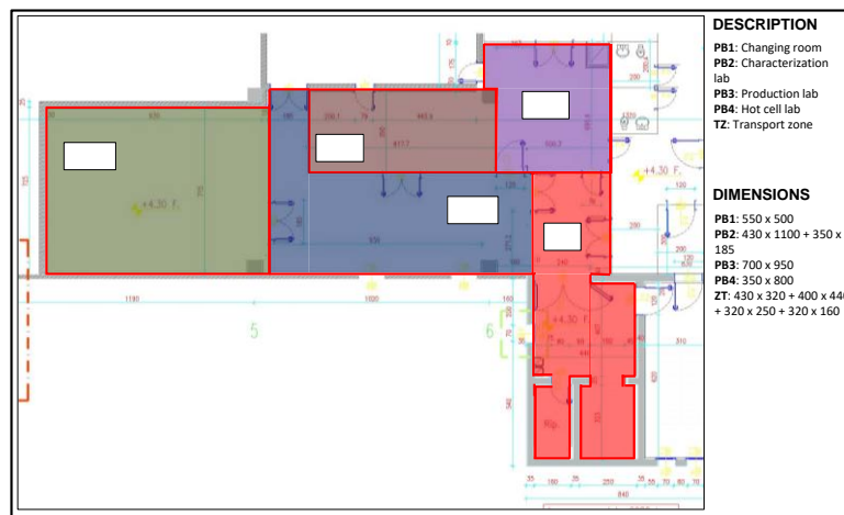
Figura 5.12 Laboratori in cui avvengono la produzione dei bersagli in carburo di silicio/uranio, la fase finale di assemblaggio dell'unità TIS e l'ispezione delle camere esauste [20].
