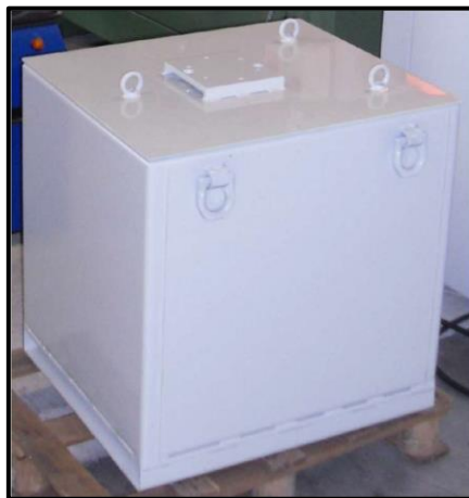
Figura 2.17 Il sarcofago che contiene la camera target.
