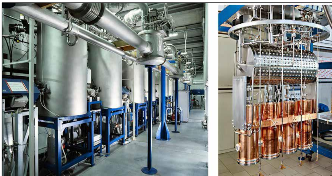
Figura 3.16 Un tratto del linac ALPI a sinistra. Sono raffigurati i criostati, recipienti contenenti le cavità superconduttive mantenute a temperature prossime allo 0 K (a T=-269\text{ }^{\circ}\text{C} ). A destra: l'interno di un criostato con 4 cavità in rame.
