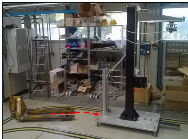
Figura 4.12 Allineamento del transpallet rispetto il sistema di estrazione.
