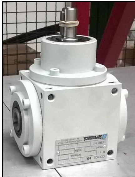
Figura 3.17 Rinvio angolare SERVOMECH BG-86-R2-SH-10-F-SU.
