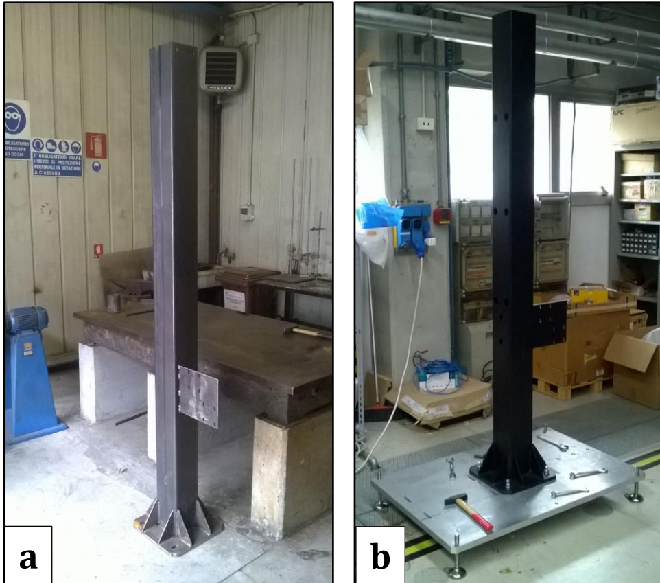
Figura 4.6 A sinistra è mostrata la struttura in ferro da verniciare, mentre a destra è mostrato il sottoassieme "B".
