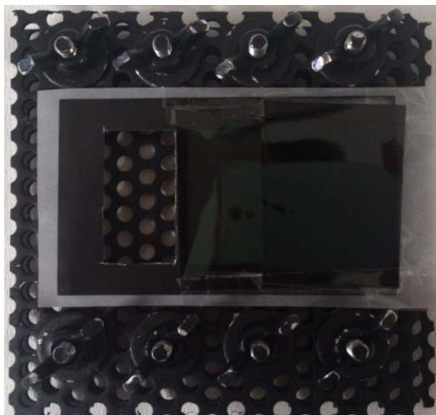
Figura 3.1: Foto dell'unità di chiusura in lamiera insieme al dispositivo di controllo dell'intensità luminosa, in grado di discriminare, per ciascuna delle tre sezioni che compongono il chip, un diverso valore di irradianza fotonica ( 360, 60 e 6 \mu\text{mol m}^{-2} \text{s}^{-1} ).
