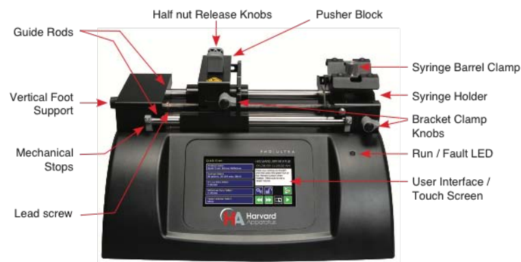
Figura 2.6: Vista frontale della PHD ULTRA™ con evidenziati i componenti e i controlli importanti. Fonte: PHD ULTRA™ Syringe Pump Series User's Guide.
