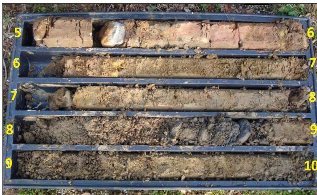
Fig.9- Cassetta catalogatrice relativa alla porzione profonda del sondaggio.
