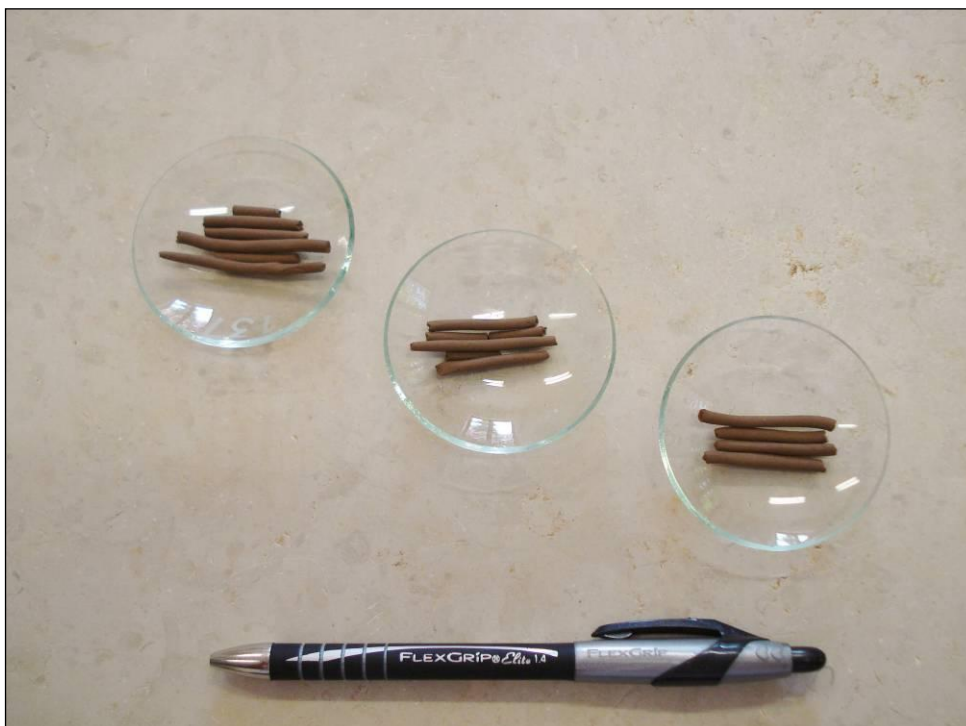
Fig.15- Set di provini realizzati per la determinazione del limite di plasticità.
