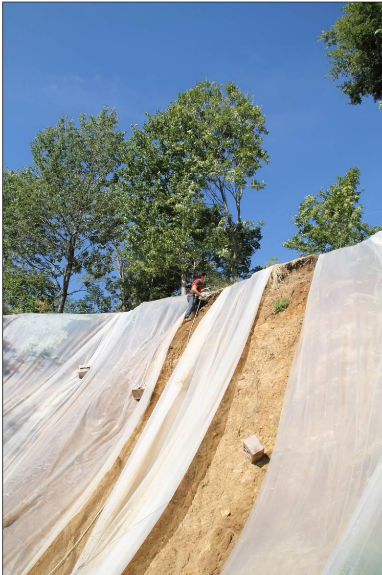
Fig.11. Campionamento sulla superficie di scivolamento della colata.
