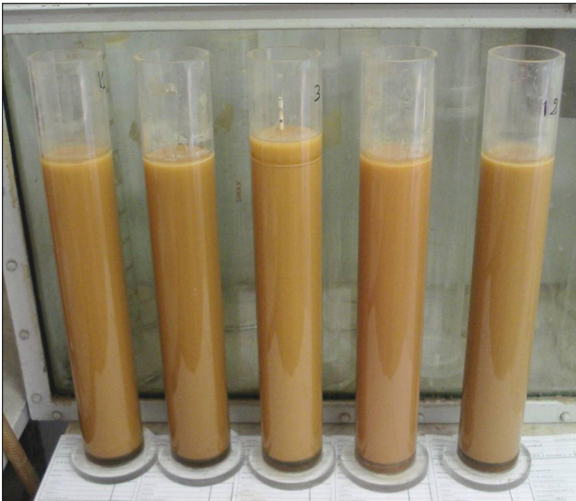
Fig.13- Set di cilindri graduati utilizzati per le aerometrie. Il cilindro centrale contiene il densimetro.
