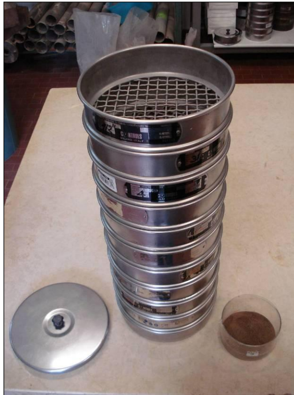
Fig.12- Pila di setacci utilizzata per la vagliatura.
