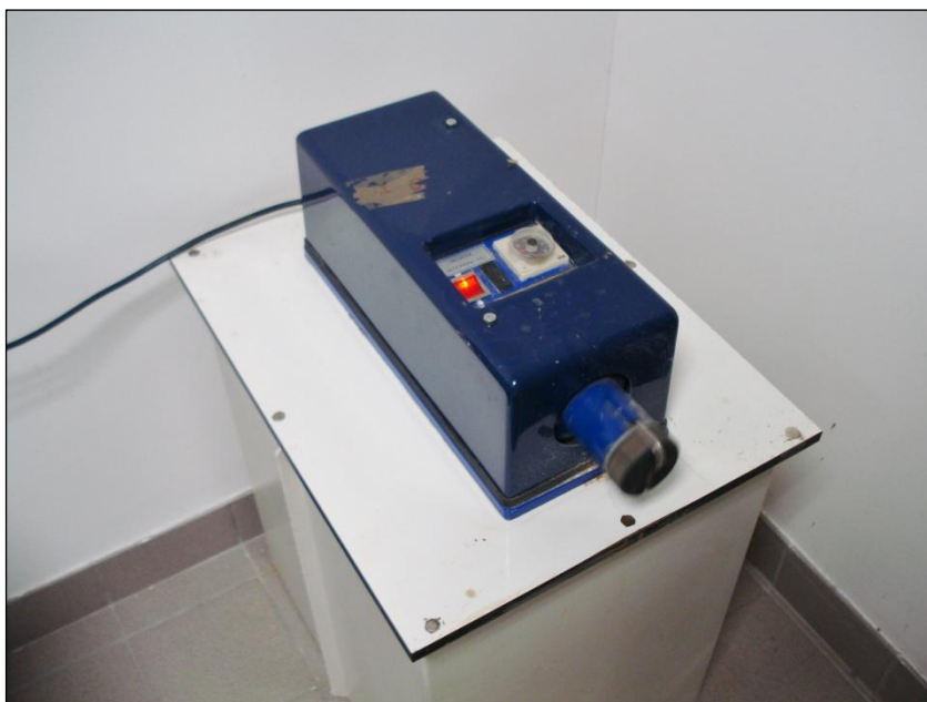
Fig.17- Macchina scuotitrice entro la quale è stato riposta la giara di micronizzazione.
