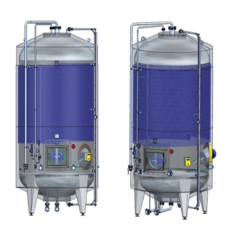
FIGURA 6.1: ACRATOPHORS - Autoclave per vino spumante.
