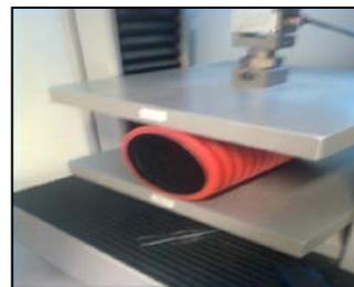
Figura 2.4.2 c : Prova di compressione
