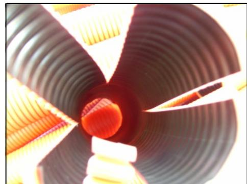
Figura 3.7 g: Sezionamento tubo per controllo spessori
