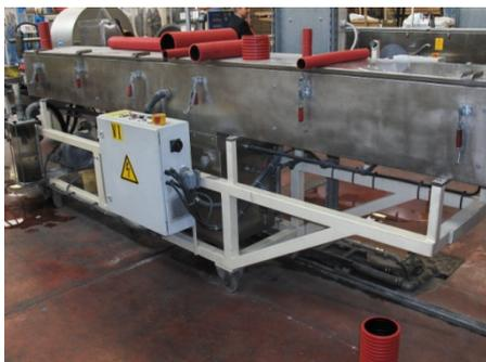
Le rimanenti gocce d'acqua presenti sono asportate prima tramite un cilindro soffiante che asporta l'umidità sulla superficie superiore, poi grazie a un elemento aspirante semi-cilindrico che elimina le gocce sulla superficie inferiore del tubo, inviando l'acqua asportata ad un serbatoio cilindro secondario (vedi Figura 3.4.4 a).
