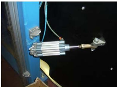
Figura 3.4.6 f: Attuatore per movimentazione
