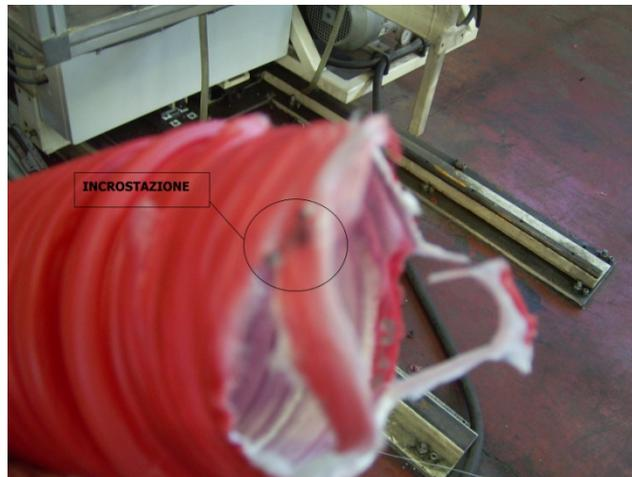
Figura 3.7 c: Rottura del tubo per incrostazione
