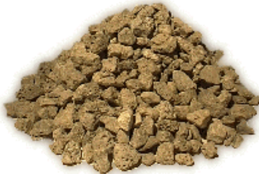
Fig. 2.9: scoria d'altoforno cristallizzata
