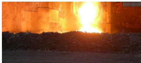
Fig. 2.4: Scorie appena rimosse dal forno elettrico
