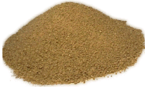
Fig. 2.10: scoria d'altoforno granulata.
