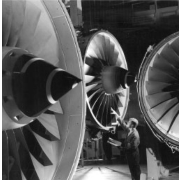
Figura 2.2: Ventole frontali di un motore commerciale Trent Rolls-Royce in Ti6Al4V [4].
