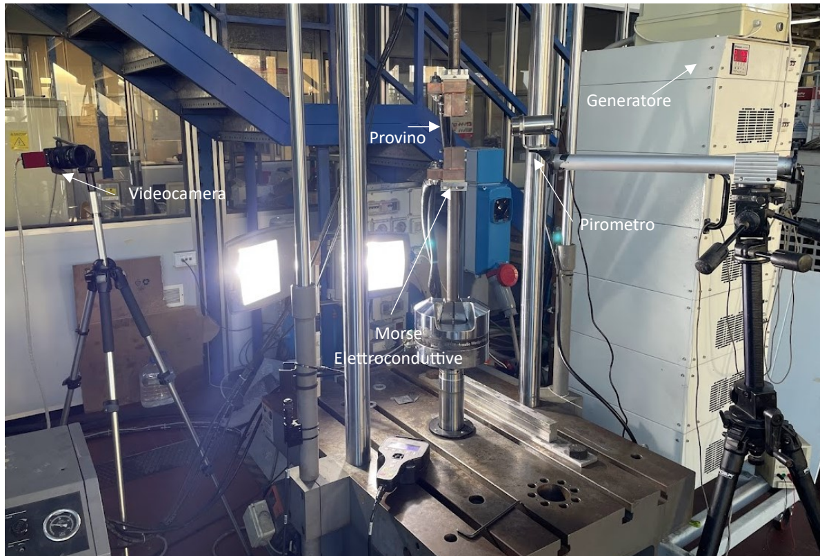
Figura 3.17: Macchina MTS equipaggiata per le prove di trazione a caldo.
