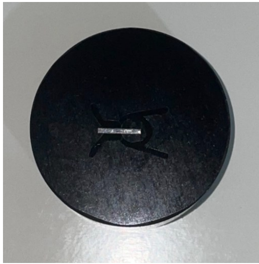
Figura 3.10: Sezione del provino dopo essere stata inglobata, lucidata e attaccata chimicamente.
