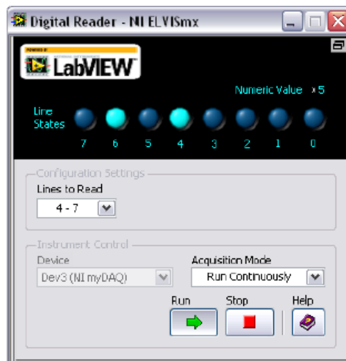
Figura 1.18: Lettore digitale SFP NI ELVISmx
