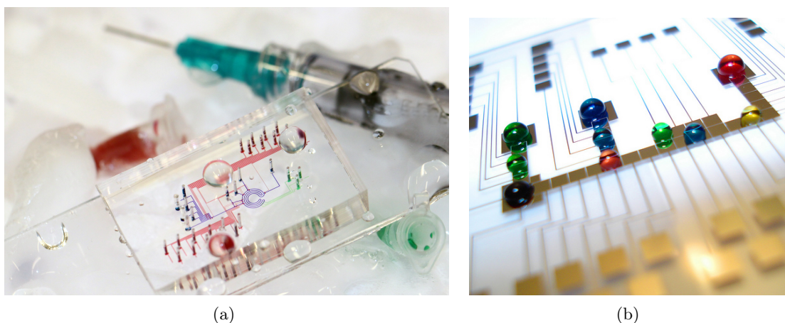
Figura 2: Esempi di dispositivi microfluidici. La Fig. (a) mostra un circuito di microfluidica chiusa in cui interagiscono vari reagenti. La Fig. (b) mostra un esempio di reattore chimico basato sul principio dell'elettrowetting [18]
