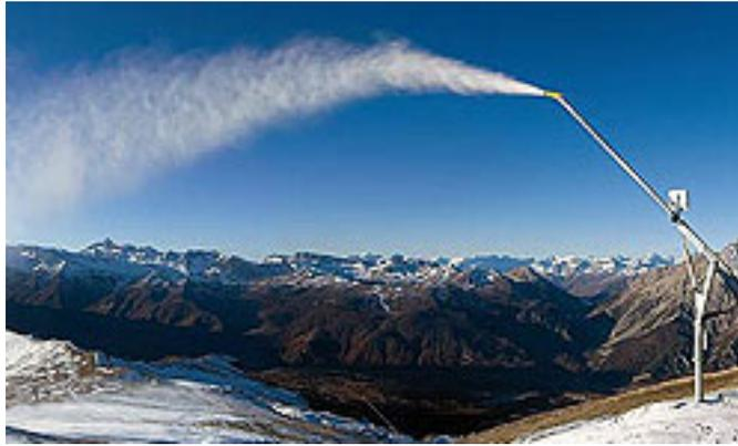
Figura 1.6: Esempio di lancia a bassa pressione
