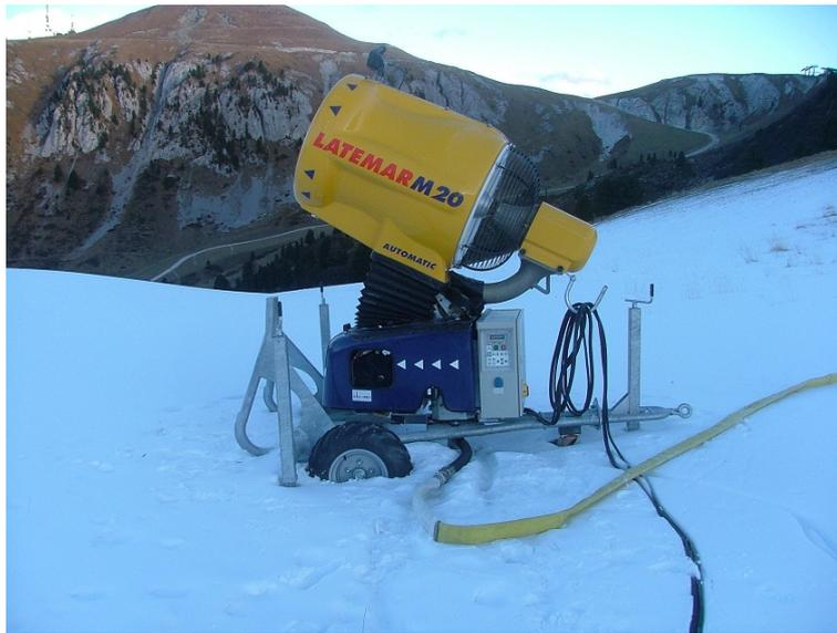
Figura 1.4: Cannone a bassa pressione Technoalpin Mod M20
