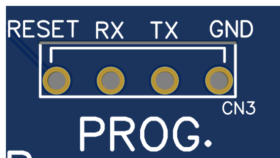
Figura 4.1: Connettore UART per raccolta dati di backup
