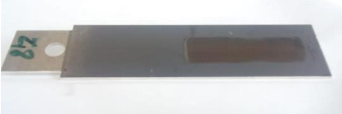
**Figura 4.17** Fotografia di un campione dopo lubrificazione e Strip Drawing Test
