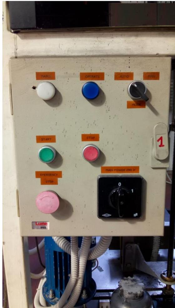
**Figura 4.9** Interruttore generale (in nero) ed altri comandi del pannello della macchina di lubrificazione
