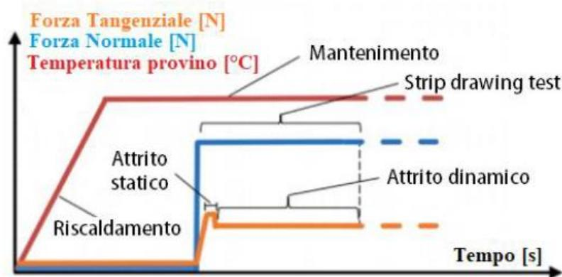
**Figura 4.20** Grafico dell'andamento delle forze e della temperatura durante Strip Drawing Test
