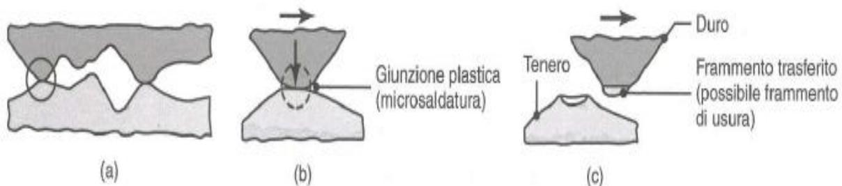
**Figura 1.5** a) Formazione dei punti di contatto b) Formazione di microgiunzioni c) Risultato dell'usura adesiva
