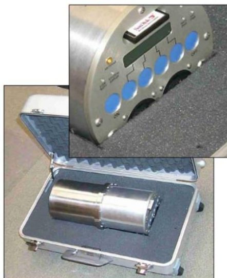
Figura 2. 6: Rivelatore di raggi cosmici nei voli aerei TEPC.
