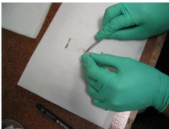
Fig. 8.3- Raschiatura del testimone con il bisturi sul vetrino.
