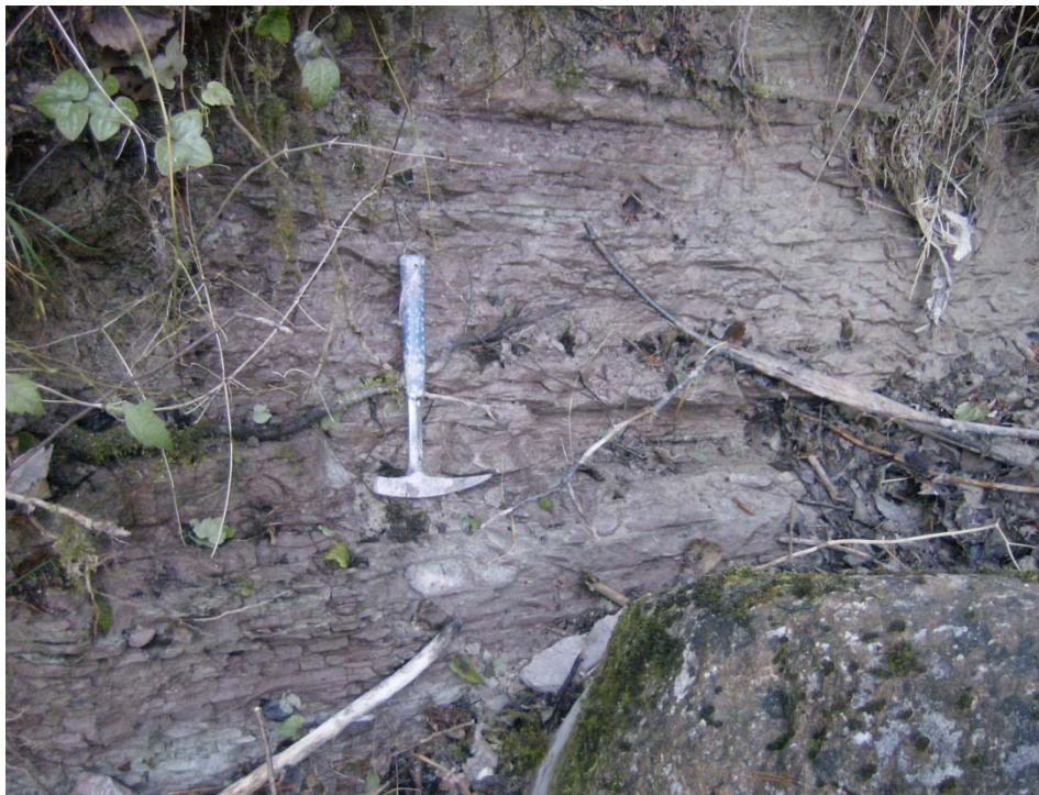
Fig. 6.7- Dettaglio della seconda anomalia litologica ( Marly Unit 2 ) costituita da marne argillose rossastre.
