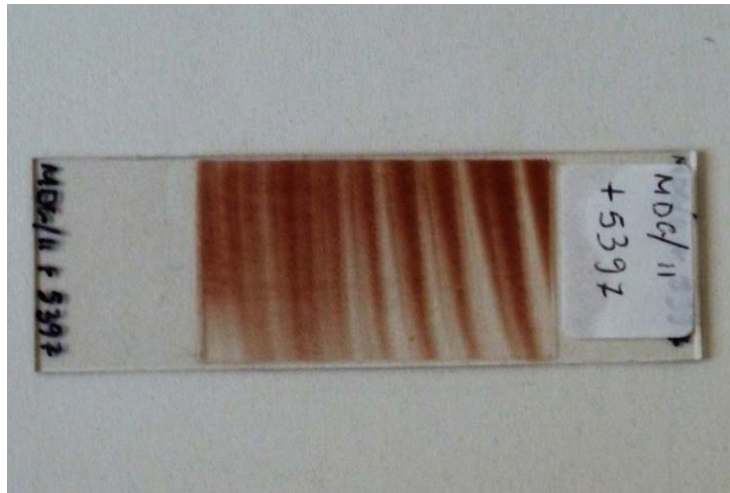
Fig.8.5 -Particolare con bande a maggior e minor densità nel vetrino.
