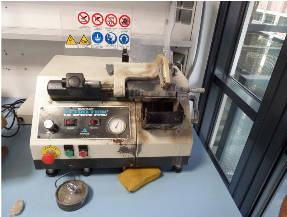
Fig. 8.16- Petro-thin utilizzato per il retrotaglio dei “chip”.
