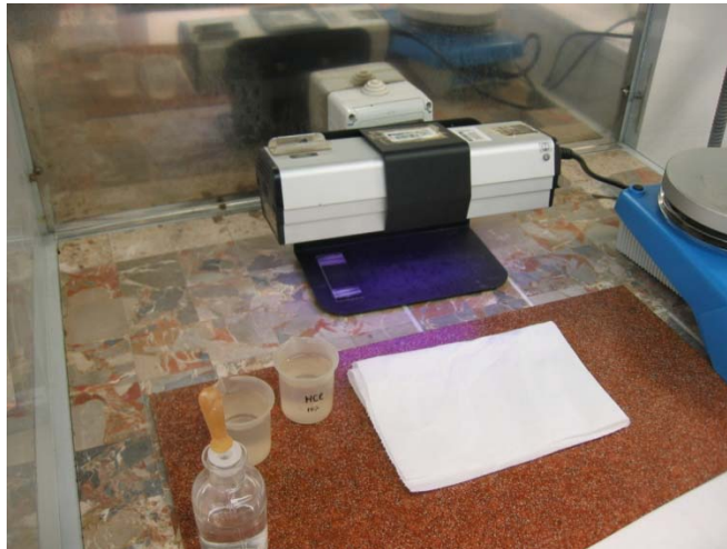
Fig. 8.8- Fase di consolidamento della colla sotto la lampada a raggi UV.
