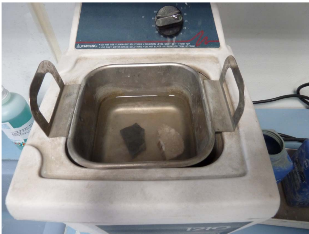
Fig.8.14- Bacinella ad ultrasuoni per il lavaggio dei “chip”.
