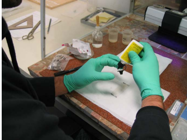
Fig.8.7- Applicazione della colla Norland.
