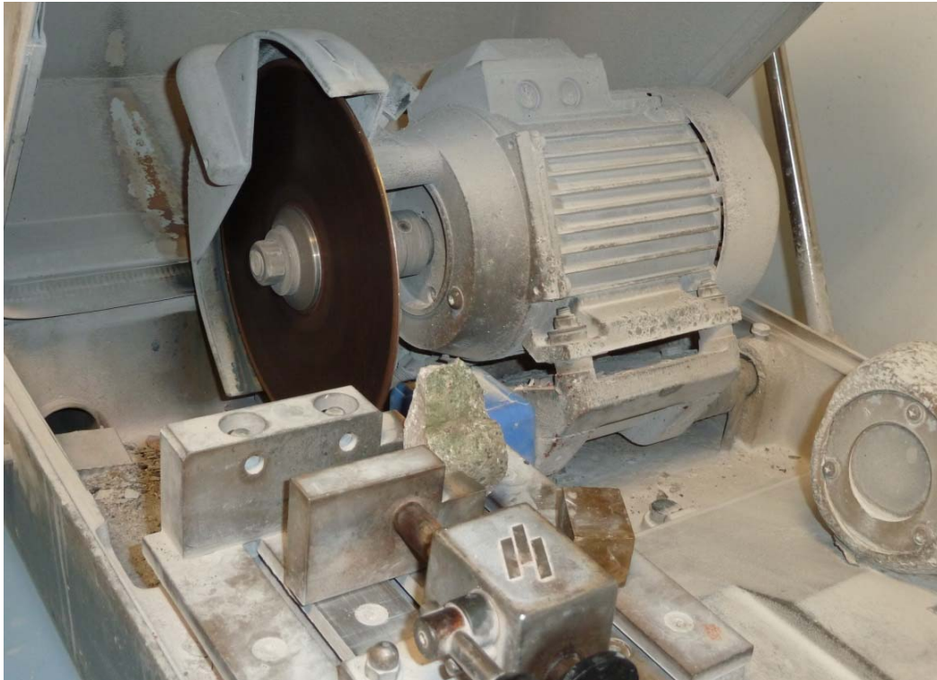
Fig. 8.12- Troncatrici che permettono di tagliare le rocce.
