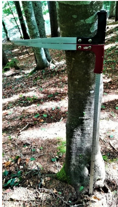
Figura 4.7 - Cavalletto dendrometrico usato durante i rilievi (Foto di Gabriele Longo).
