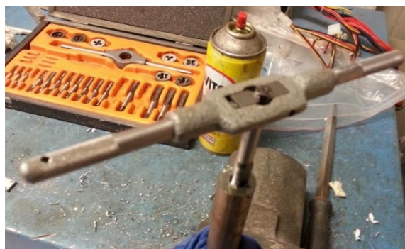
Figura 3.13- Filettatura foro con maschio M10
