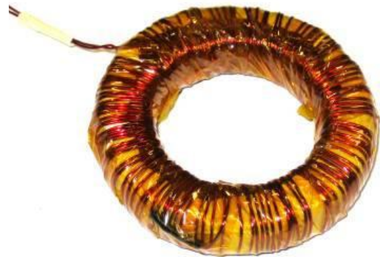
Figura 3.15- Sonda Rogowski utilizzata nel circuito
