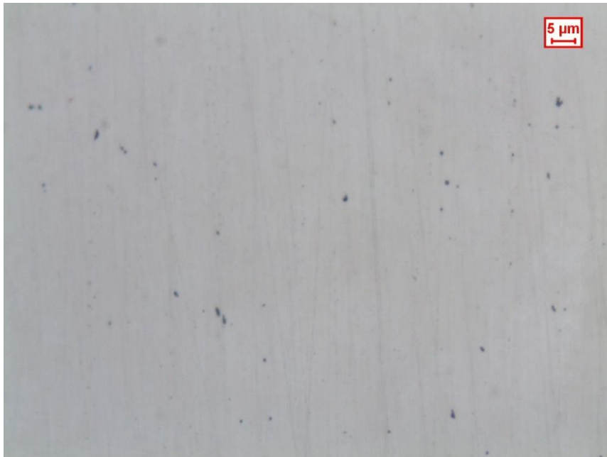
Figura 3.5- Micrografia del campione a CUORE prima dell'attacco chimico con ingrandimento 500x
