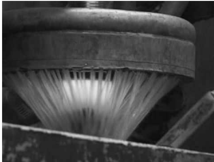
Figura 2.5- Esempio di sistema di raffreddamento ad ugelli posto in seguito alle spire dell'induttore (sistema con pezzo-induttore in movimento)
