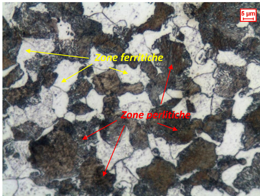
Figura 3.9- Micrografia del campione a CUORE dopo l'attacco chimico con ingrandimento 500x
