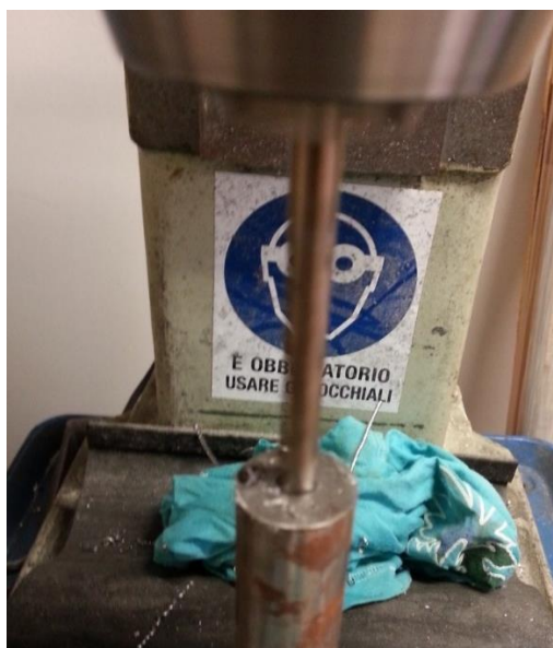
Figura 3.12- Foratura campione con punta \varnothing 9.5 tramite trapano verticale
