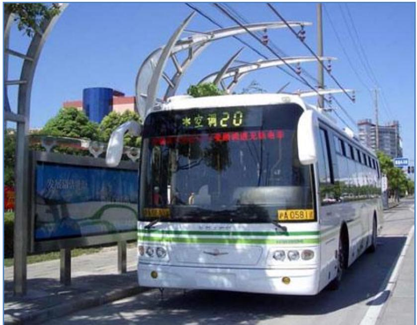
Figura 22 – Un autobus elettrico a supercondensatore. Si noti il punto di allacciamento aereo presente al di sopra della fermata.
