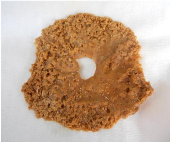
Fig. 11 Esplosivo decantato
