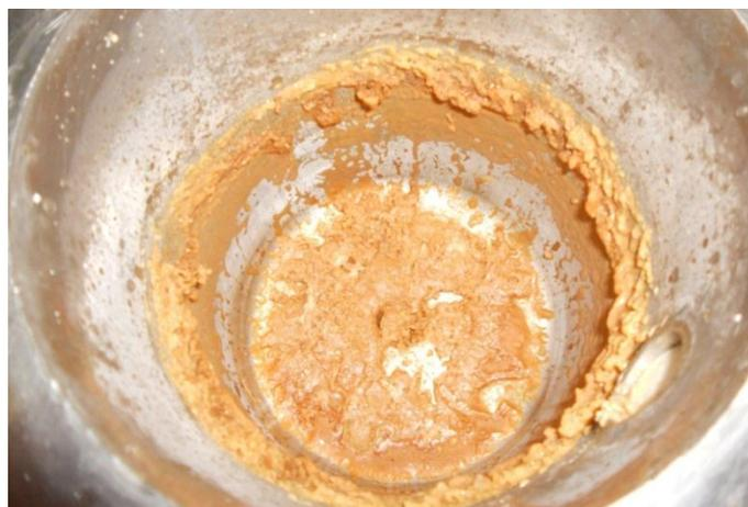
Fig. 13 Incrostazioni di esplosivo in seguito a raffreddamento sotto gli 80 °C
