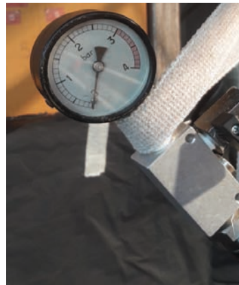
Figura 18 – Barometro montato a monte degli ugelli (a sinistra) e barometro montato a valle degli ugelli (a destra).
