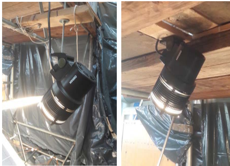
Figura 20 – Lampade in uso: a sinistra la lampada centrata nella parte bassa del modulo; a destra la lampada centrata nella parte alta del modulo
