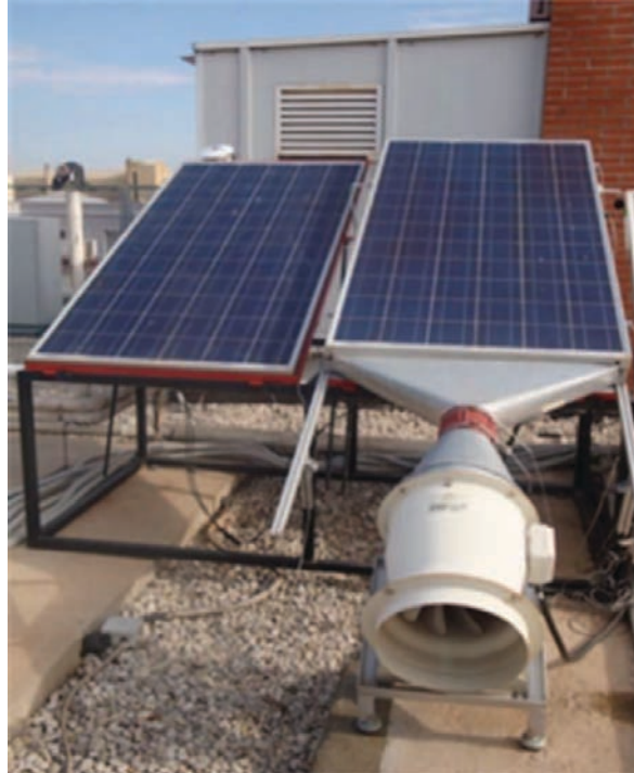
Figura 7 - Setup sperimentale per la tecnica di raffreddamento ad aria con ventilatore
