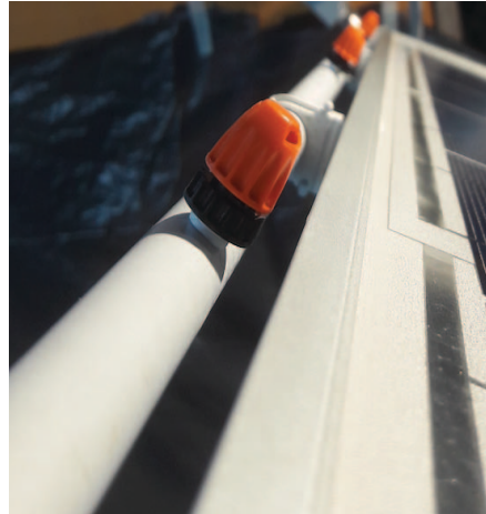
Figura 50 – 2 a configurazione di ugelli: angolo di inclinazione rispetto al piano orizzontale pari a 53°.
