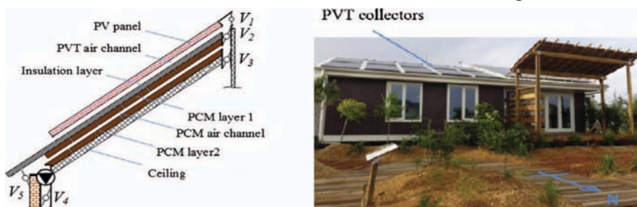
Figura 10 - Schema semplificato di un nuovo sistema di ventilazione a soffitto per collettori solati FV/T.
