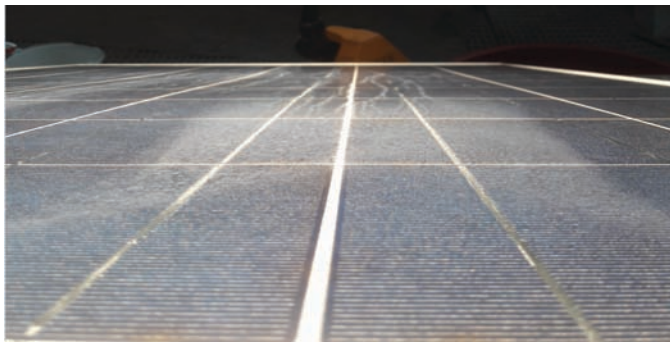
Figura 38 - Formazione di calcare nel ciclo 30s ON - 180s OFF alla pressione di 0.5 bar.
