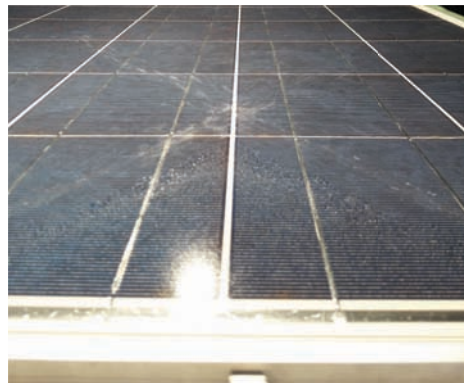
Figura 52 - Incrocio dei due getti provenienti dal 1° e 2° ugello sulla colonna di celle da 04 a 44.
