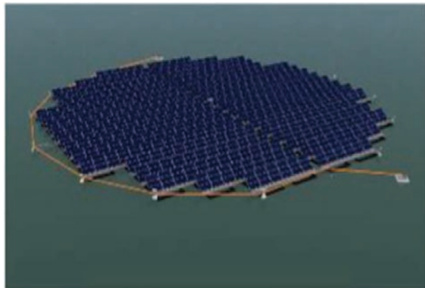
Figura 99 – Sistema di tracking con corda
