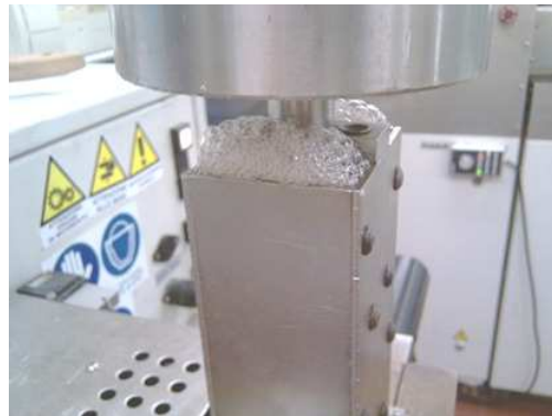
Figura 32 Trafilamento di plastificante dalla bocca della tramoggia di inserimento del plastografo
