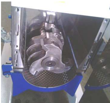
Figura 35 Particolare della camera di taglio del granulatore MainTech s.r.l. GRL160 con cui sono stati granulati i compound in uscita dal plastografo
