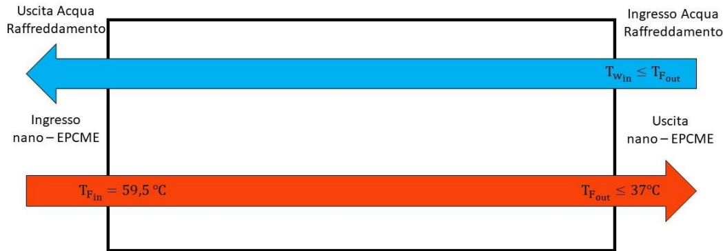
Figura 42 Schema Semplificato del Raffreddatore
