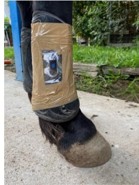
*Figura 2.8 Rivestimento della sonda con il cellophane*
