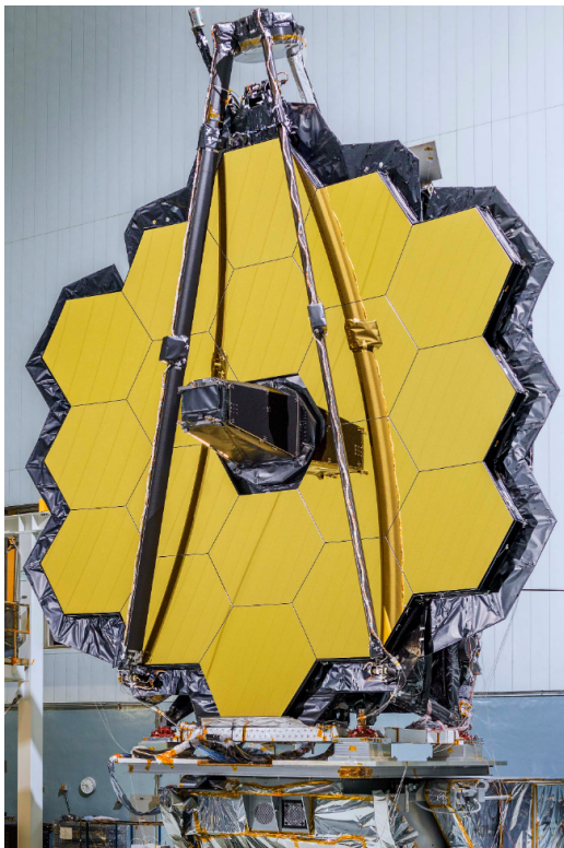
Figura 2.2: Specchio principale del JWST si possono notare i 18 esagoni che compongono lo specchio primario.
