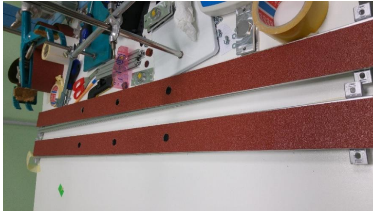
Figura 2.24 pareti laterali del condotto verticale rivestite di carta vetrata. I trasduttori si innestano in corrispondenza dei fori.
