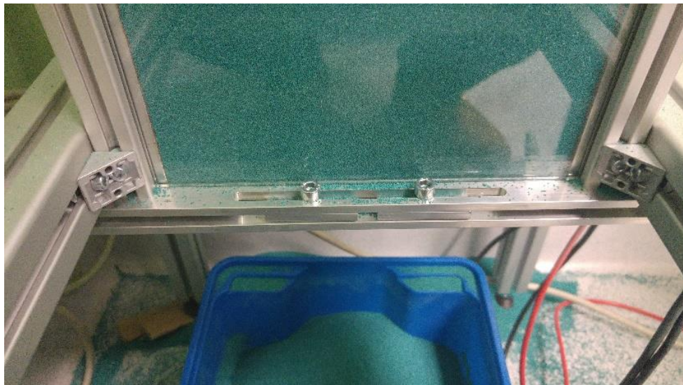
Figura 2.21 particolare dello scarico a feritoia regolabile
