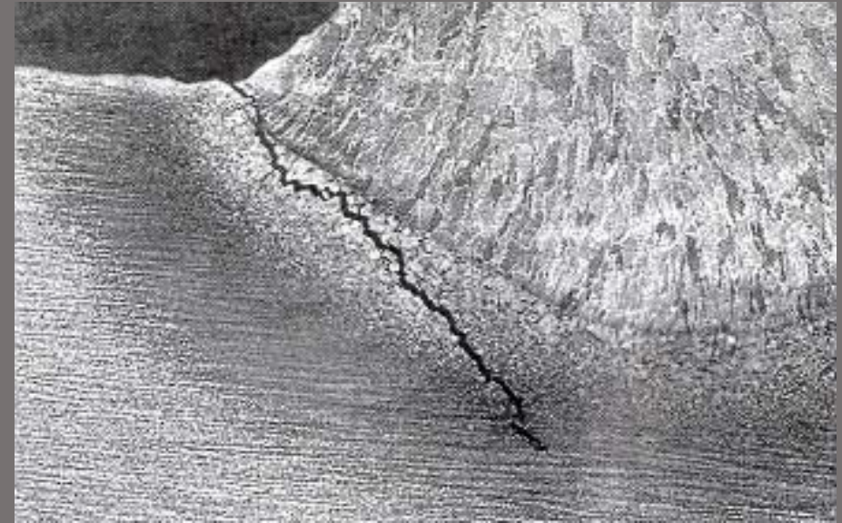
Difetto tipico da penetrazione d'idrogeno nella zona termicamente alterata (criccabilità a freddo). ( https://www.itrsystem.com )
