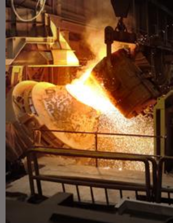
Forno a tre elettrodi a sinistra e convertitore AOD a destra. ( www.safas.it )
