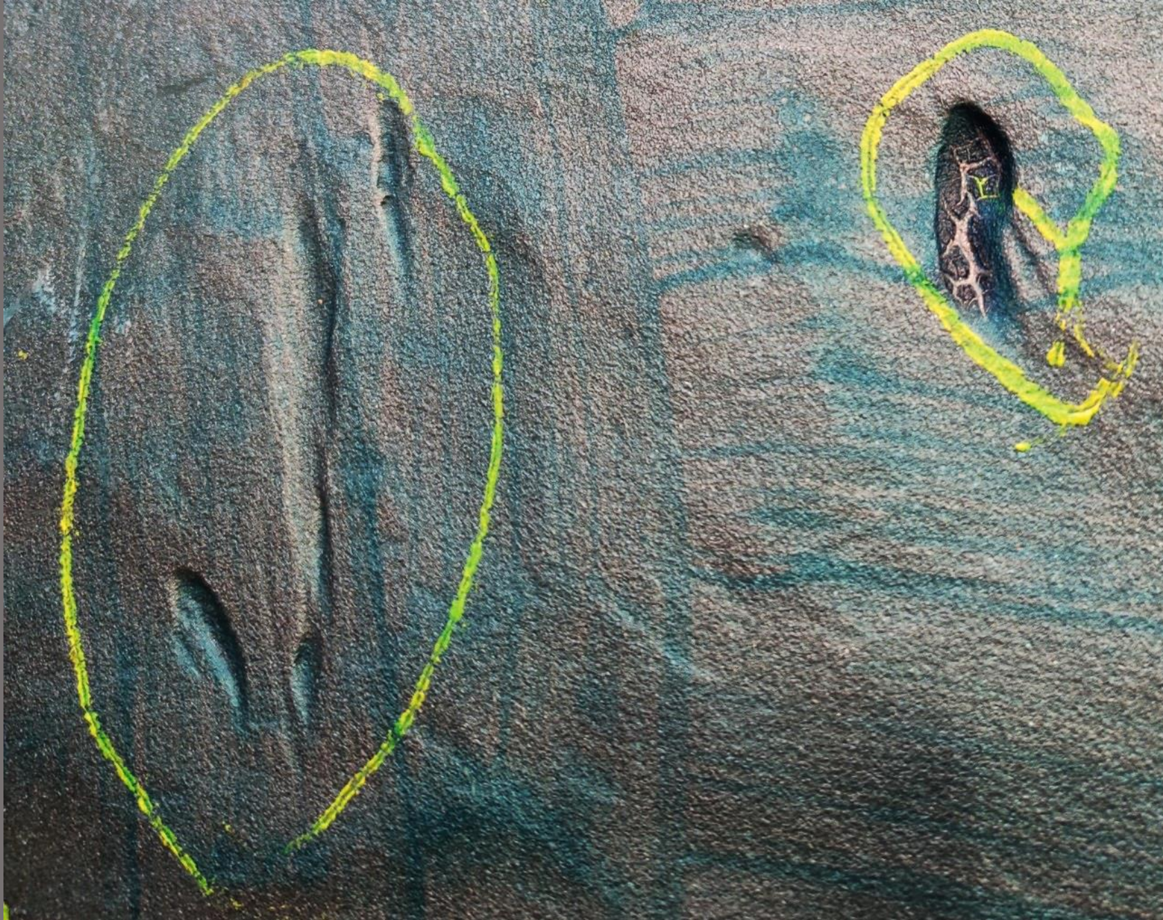
Immagine di un getto con evidenziati i difetti da asportare.
