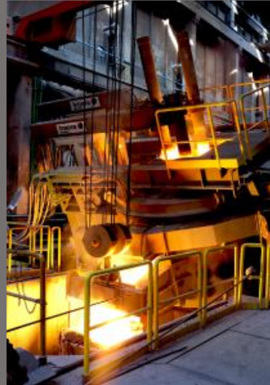
Forno a tre elettrodi a sinistra e convertitore AOD a destra. ( www.safas.it )
