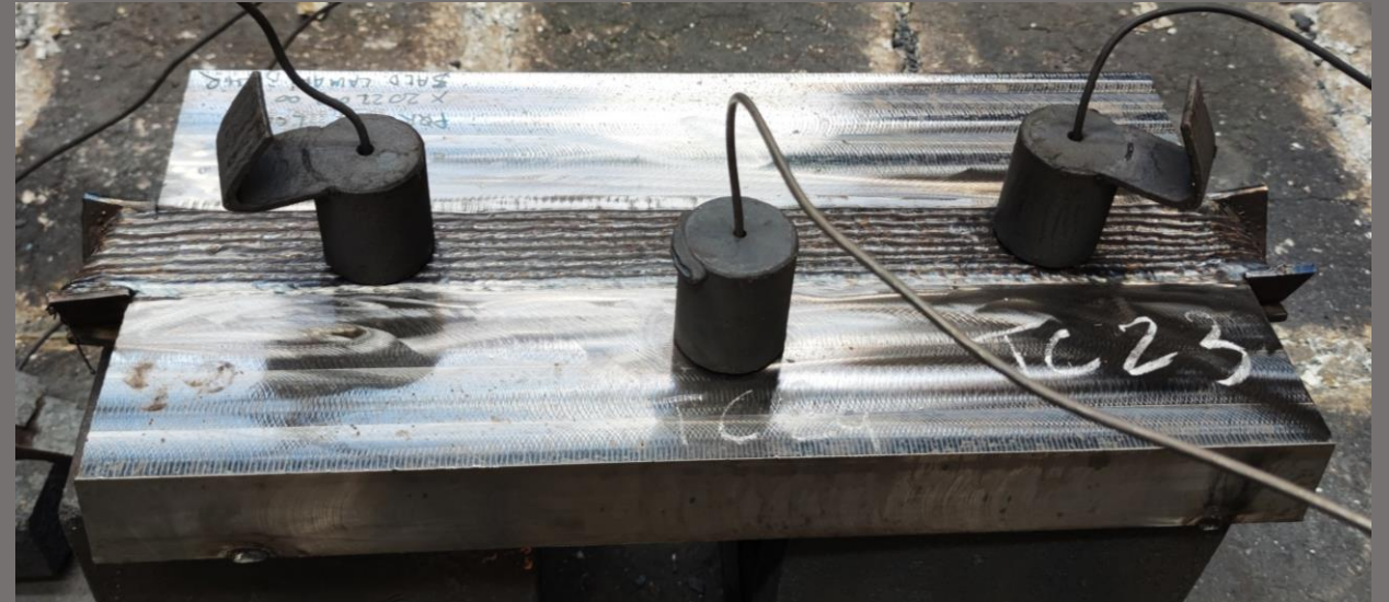
Immagine della piastra prima del trattamento termico di distensione con tre termocoppie rilevatrici della temperatura della piastra.
