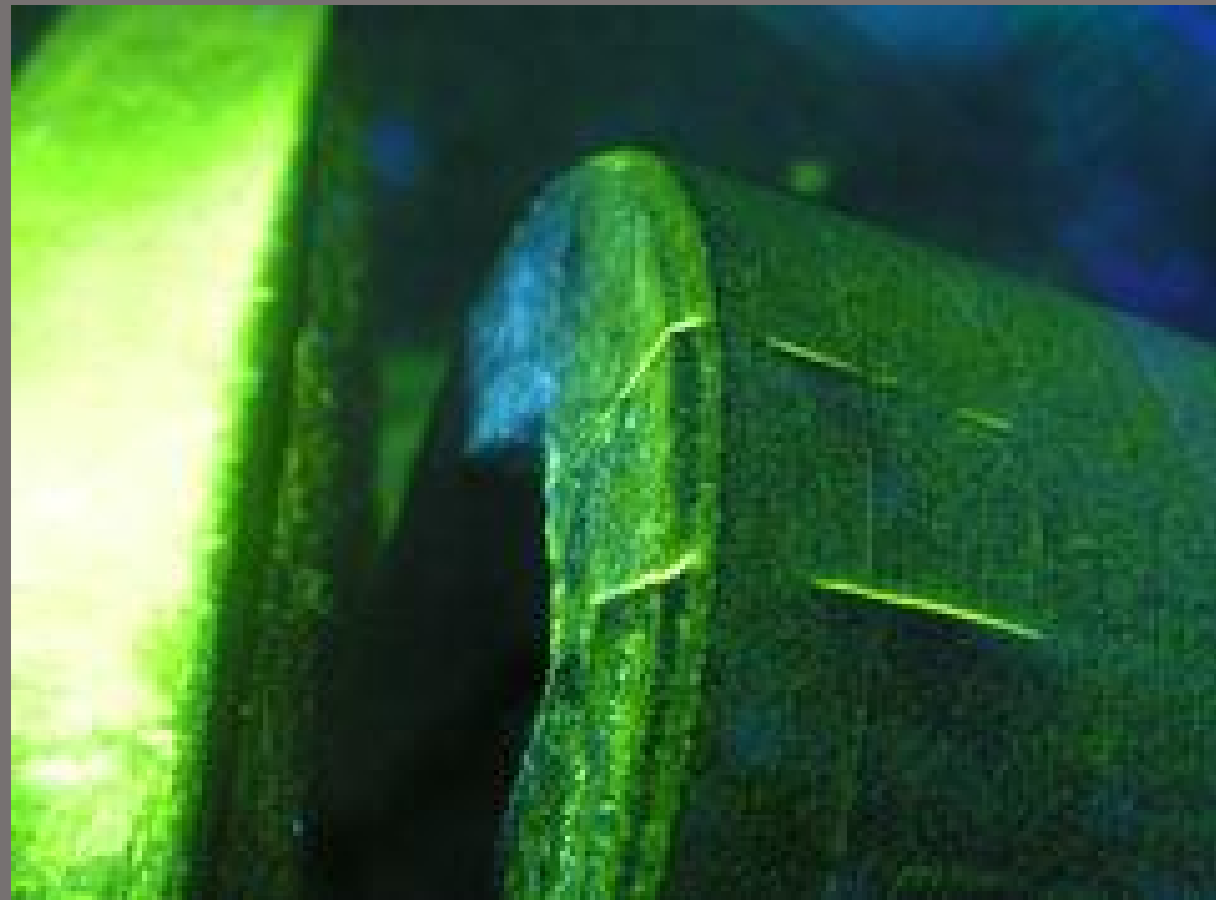
Cricche evidenziate dalla magnetoscopia. ( www.controlli.it )
