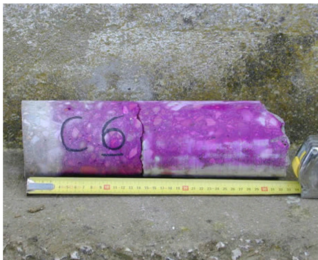
Figura 2.14 - Prova con la fenolftaleina.
