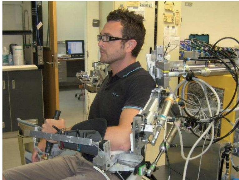
Figura 1.2: Il Pnew-WREX , un dispositivo robotico - esoscheletro - guidato da attuatori pneumatici.
