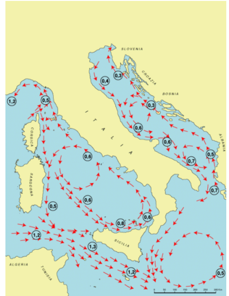
Velocità espressa in nodi delle correnti marine nei pressi delle coste italiane nel mese di Giugno
