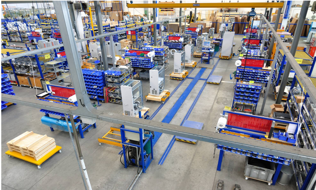
Figura 5.9: Linea D5 dopo ristrutturazione in ottica Lean
