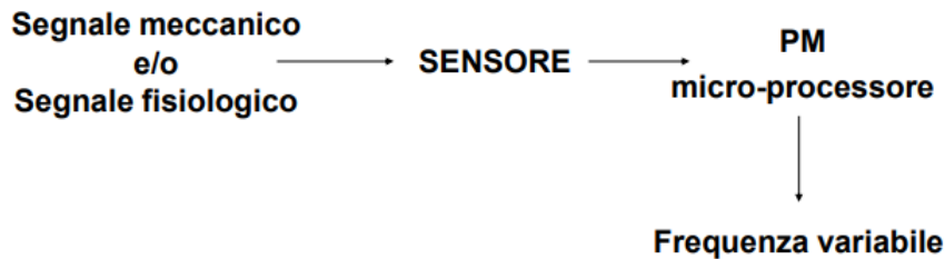
Figura 2.16 Funzionamento di un pacemaker Rate-responsive: sensori specifici rilevano segnali metabolici e fisiologici e determinano le variazioni di frequenza cardiaca.
