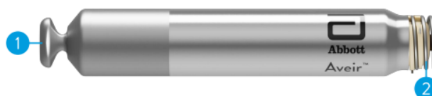
Figura 3.11 Componenti di un pacemaker AVEIR VR Ventricular. Lunghezza: 38 mm. Diametro: 6,5 mm.
