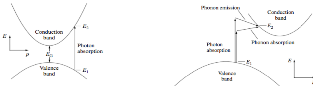
Figura 1.9: differenza nel diagramma a bande tra un semiconduttore a gap diretto (a sinistra) ed uno a gap indiretto (a destra). (dal libro "Handbook Of Photovoltaic Science And Engineering")
