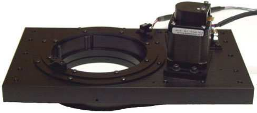
Figura 4.2: Montature della phase plate con un motore elettrico per poterla ruotare a diverse velocità
