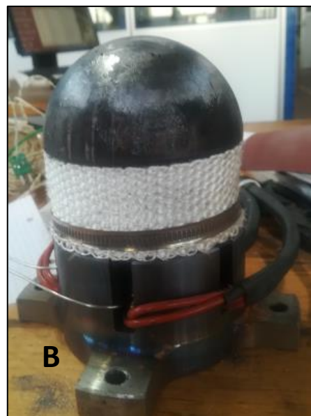
FIGURA 67: A) MACCHINA NAKAZIMA; B) PUNZONE DELLA MACCHINA NAKAZIMA IMPIEGATO NELLE PROVE
