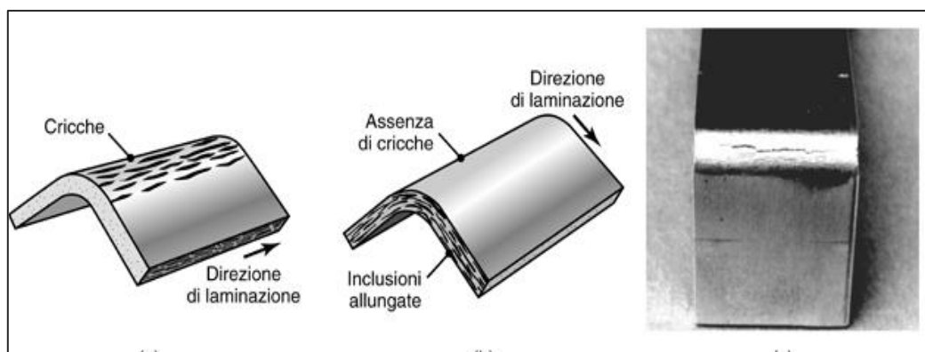
FIGURA 26 RELAZIONE PIEGATURA E DIREZIONE DI LAMINAZIONE
