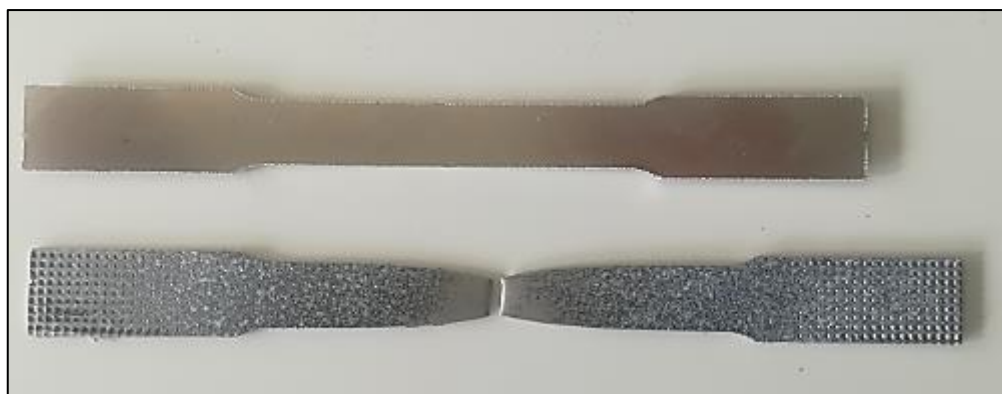
FIGURA 39 FOTO CAMPIONE DI ALLUMINIO AA6082 PRIMA E DOPO LA PROVA DI TRAZIONE
