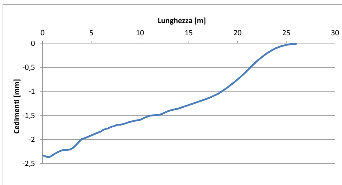
Fig. 67 Cedimenti verticali lungo il tunnel.
