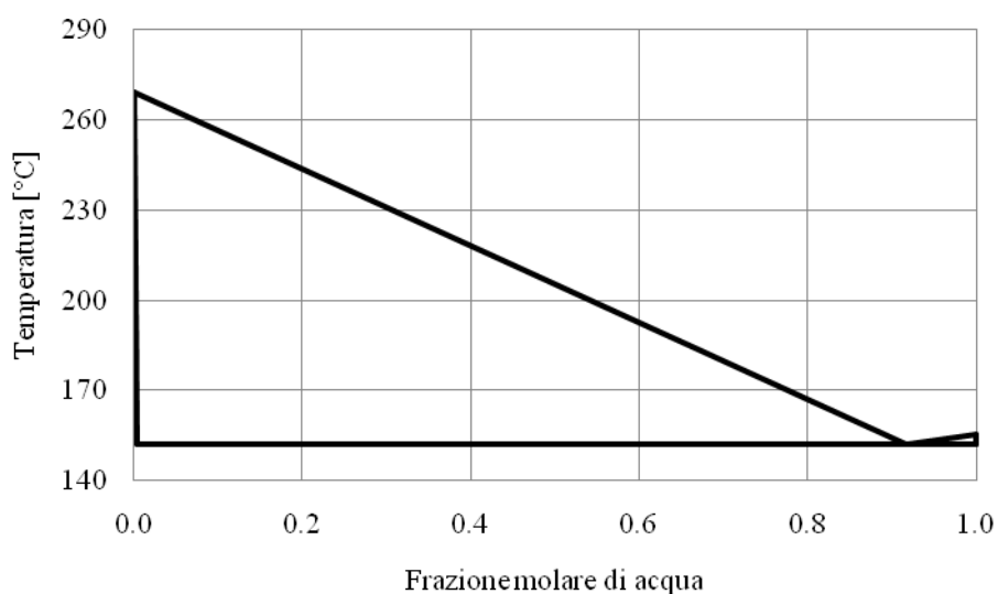
Figura 3.8: Grafico x-y-T a P=550 kPa per la coppia acqua-indene con dati ottenuti dal simulatore PRO II usando il modello termodinamico UNIFAC
