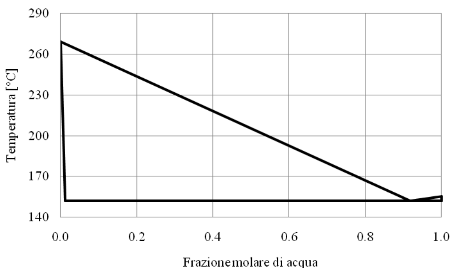
Figura 3.9: Grafico x-y-T a P=550 kPa per la coppia acqua-indene ottenuto plottando i dati forniti da PRO II utilizzando come modello termodinamico NRTL dopo aver regredito i parametri di interazione binari
