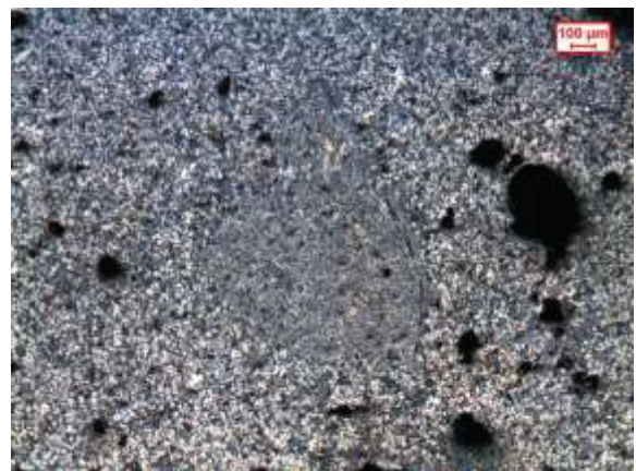
Figura 26: micrografia del getto Q4 zona centrale: dettaglio di inclusioni nella matrice provenienti da gocce di lega presolidificate in camera d'iniezione
