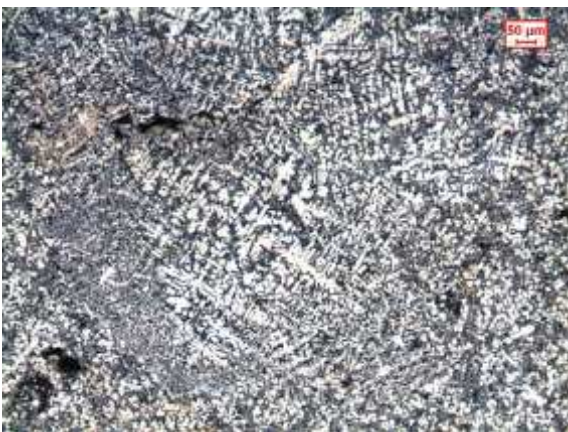
Figura 26: micrografia del getto Q4 zona centrale: dettaglio di inclusioni nella matrice provenienti da gocce di lega presolidificate in camera d'iniezione
