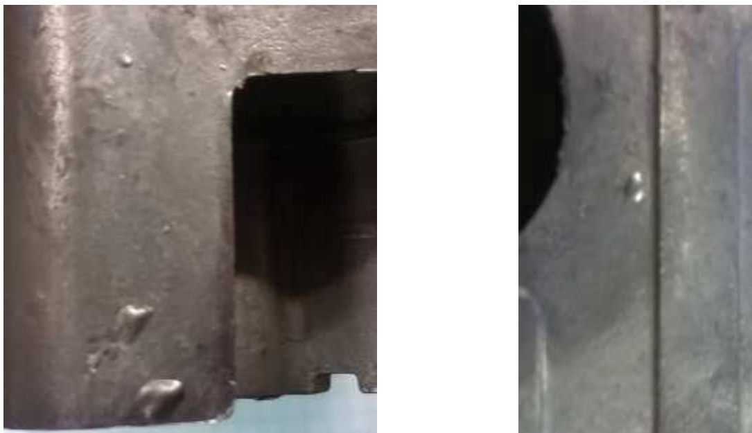
Figura 15: esempio di blister superficiali
