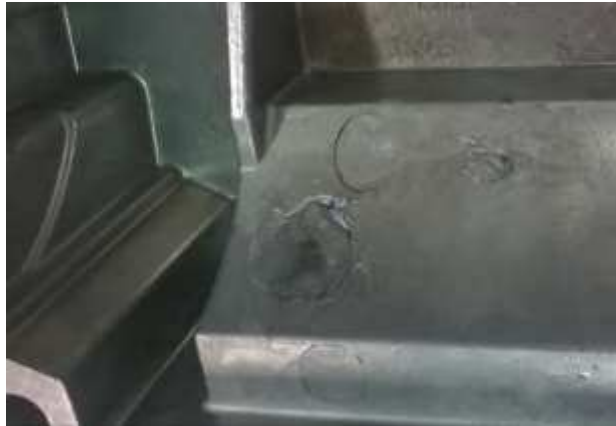
Figura 14: esempio di mancato completamento del getto RDS
