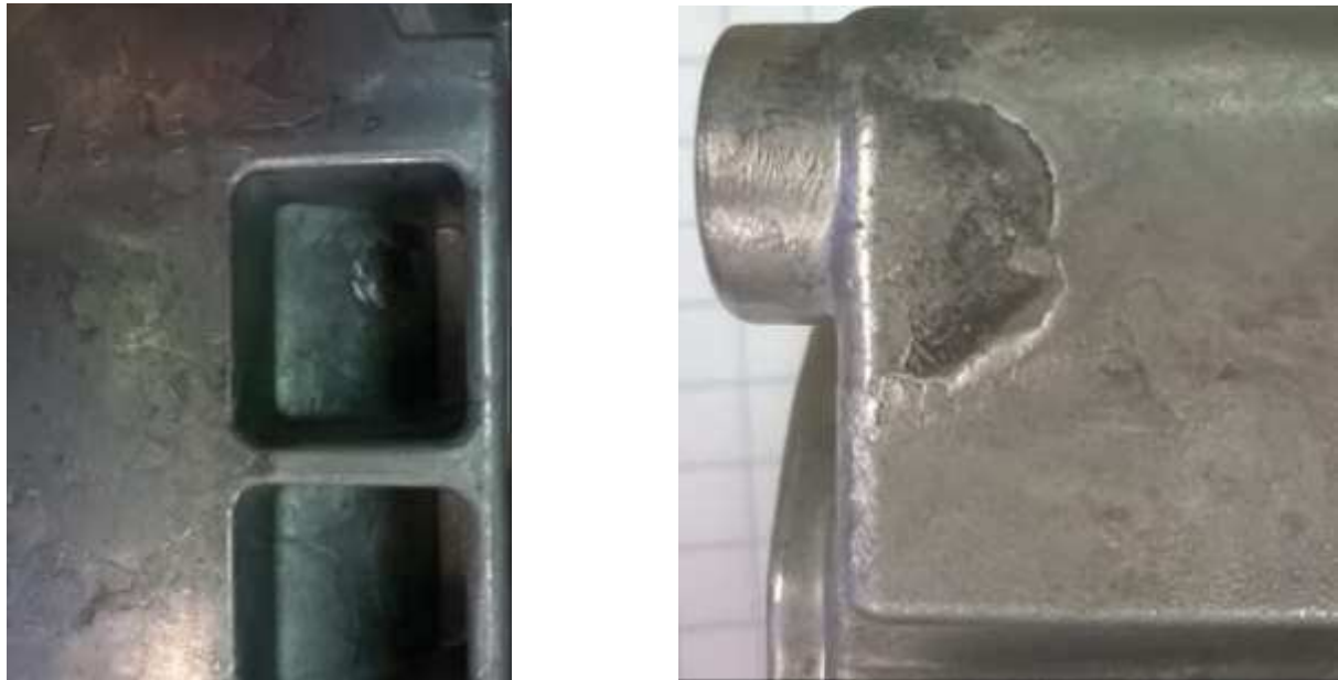
Figura 16: esempio di giunzioni a freddo superficiali e flussi turbolenti
