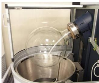
**Figura 6.8: Particolare del pallone di evaporazione, all'interno del quale viene immessa la soluzione da concentrare.**
