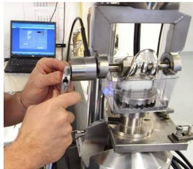
**Figura 7.50: funzionamento della strumentazione: la rotazione della componente protesica femorale viene indotta manualmente e il momento torcente registrato tramite software.**
