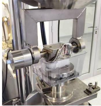
**Figura 7.49: Strumentazione utilizzata per la prova: MTS Landmark 370 con struttura appositamente adattata per l'applicazione del carico su una protesi di ginocchio.**
