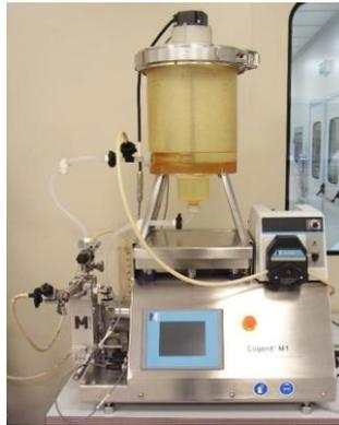
Figura 6.4: Cogent M1 per la filtrazione del polimero di CMCA.
