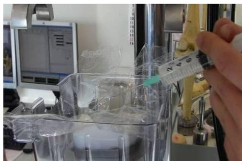
**Figura 7.31: preparazione della prova con gel: l'idrogel viene versato sui condili mediante l'uso di una siringa.**
