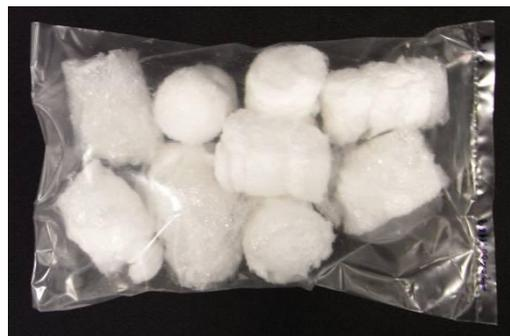
Figura 6.11: idrogel di CMCA liofilizzato.
