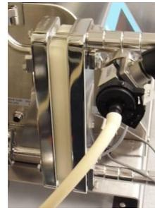
Figura 6.5: Particolare della membrana utilizzata per la filtrazione.
