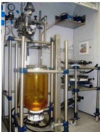
Figura 6.13: Reattore chimico all'interno del quale avviene la reazione di ammidazione.
