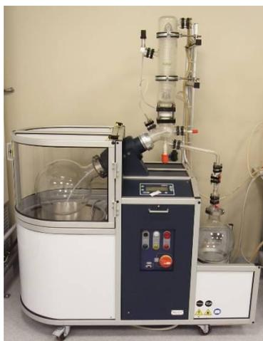
Figura 6.7: Evaporatore rotante (Rotavapor) per l'evaporazione a bassa pressione.
