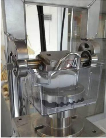
Figura 7.24: Strumentazione utilizzata per l'applicazione del carico con la struttura adattata per la protesi di ginocchio.
