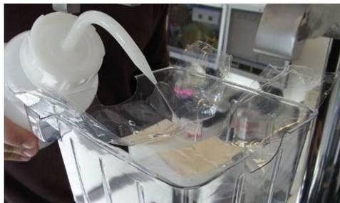
**Figura 7.30: preparazione della prova con acqua: l'acqua viene versata sopra le sezioni di film adagate sui condili.**
