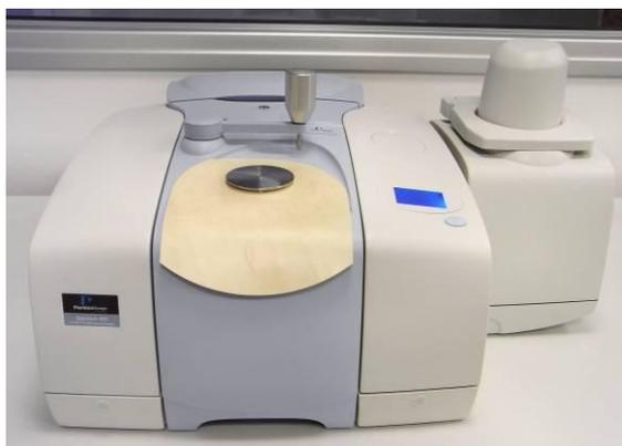
Figura 7.16: Spettrometro IR PerkinElmer Spectrum 400.
