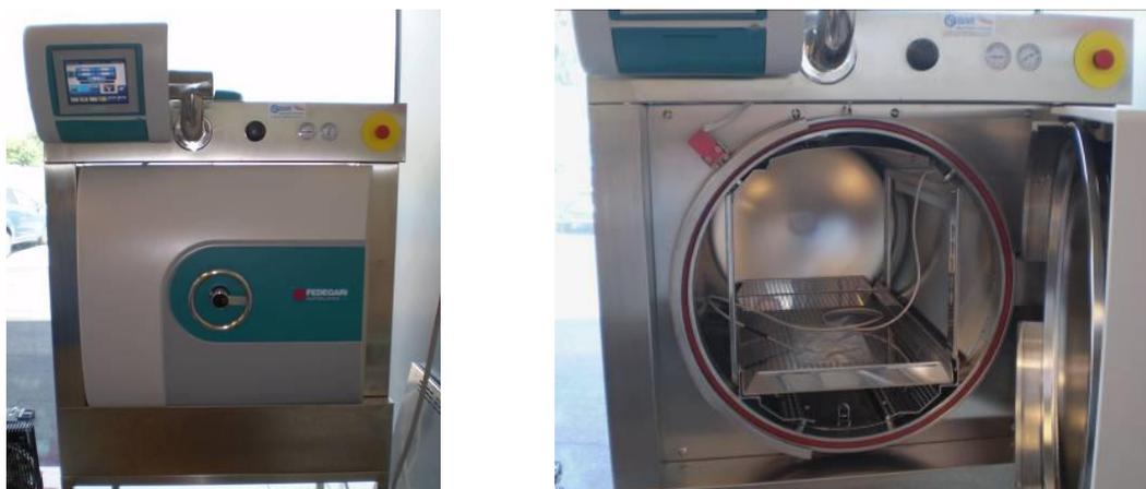
Figura 9.19: autoclave Fedegari FOB3 per la sterilizzazione mediante calore.
