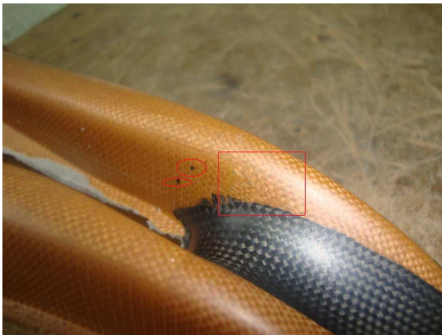
Figura 2.7: nei tondi rossi, scarti di carbonio depositati tra fibra di vetro e matrice. Nel riquadro: errata deposizione delle pelli che ha interrotto la continuità nella trama.
