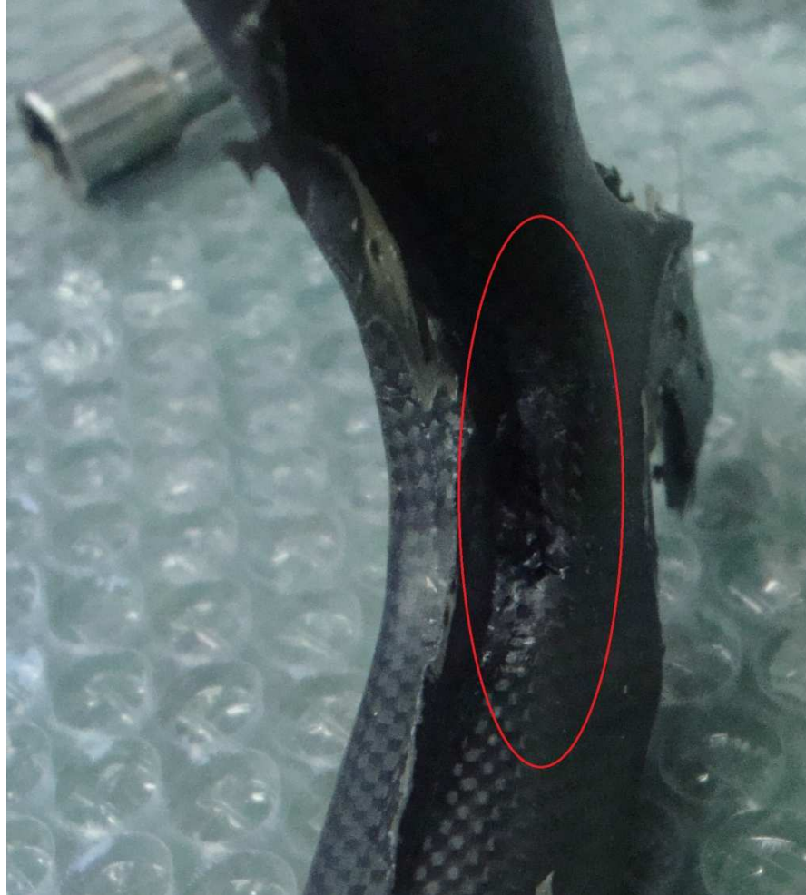
Figura 2.5: deposizione del preimpregnato non corretta
