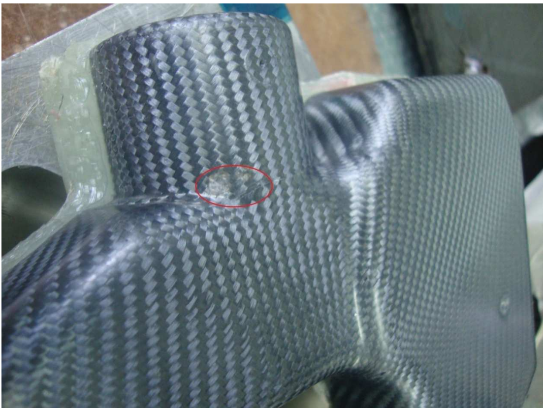
Figura 2.8: difetto dovuto alla presenza di sporco nello stampo.
