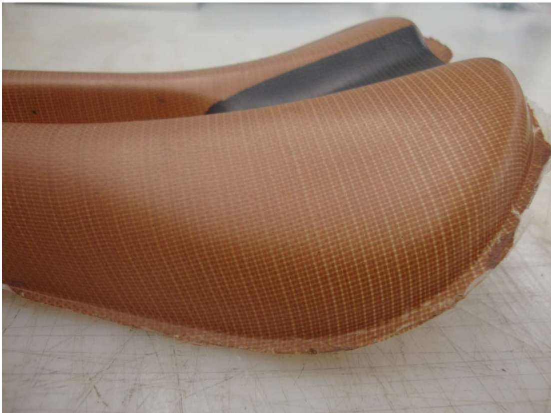
Figura 2.6: effetti dell'utilizzo di un collante tra stampo e fibra di vetro, seguita da vuoto di consolidamento.
