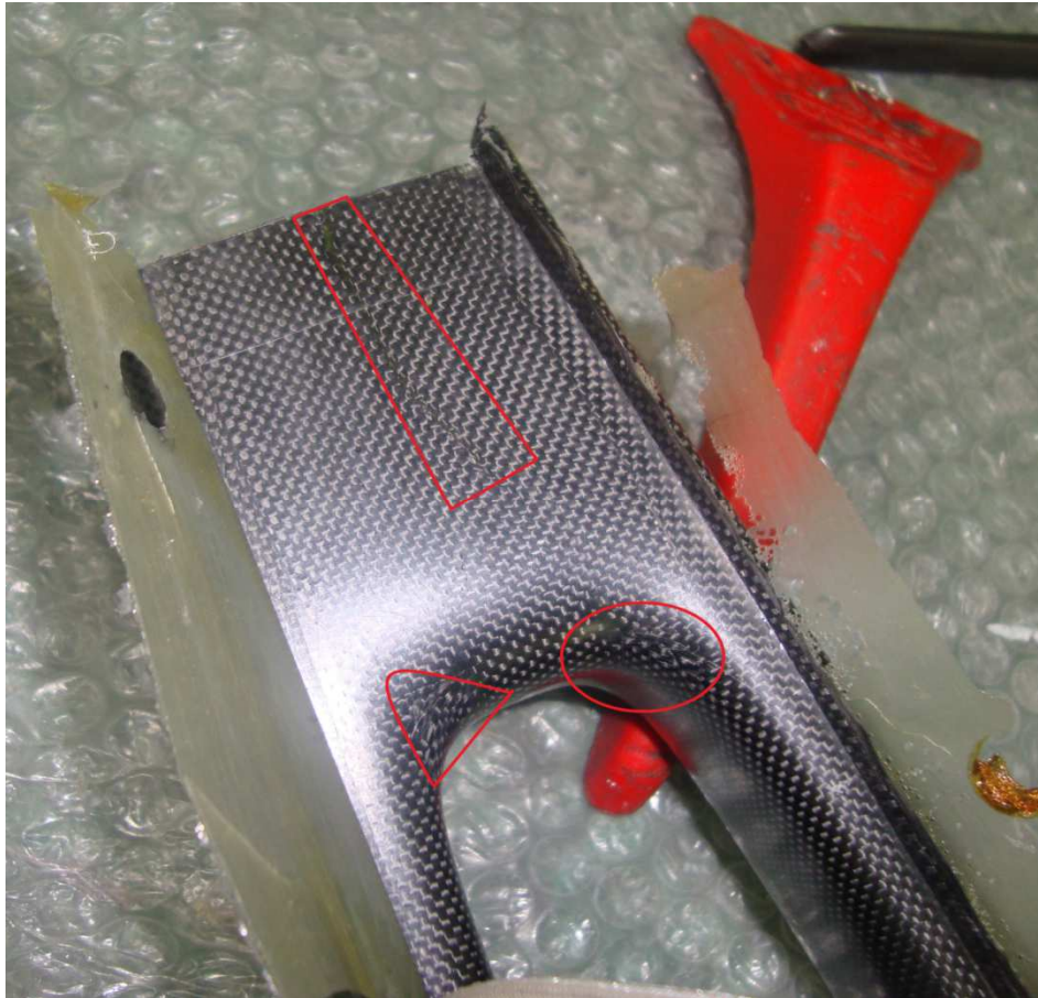
Figura 2.4: accumulo di resina causato dall'inserimento del mandrino.
