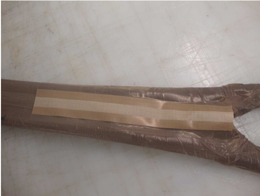
Figura 2.3: rete in teflon posta sul mandrino per aumentarne l'aderenza
