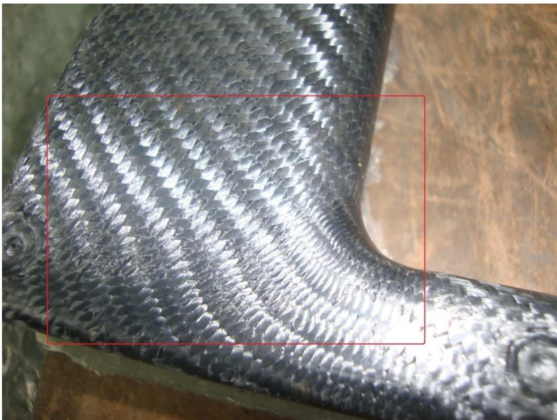
Figura 2.9: la perdita di depressione del sacco da vuoto non ha permesso una distribuzione omogenea della resina né la sua completa polimerizzazione.
