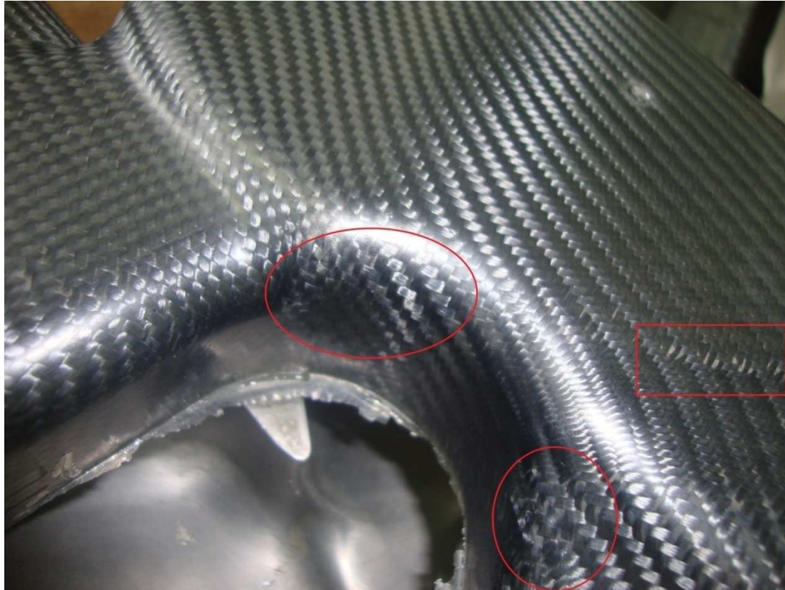
Figura 2.10: errata deposizione delle pelli esterne che portano a una stiratura o interruzione della trama.
