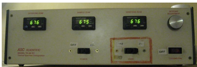
Fig. 4.5: Smagnetizzatore termico (sopra) e relativo controller (a sinistra).
