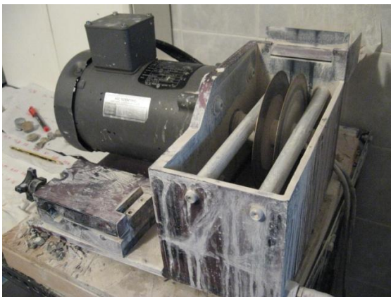
Fig. 4.2: Sega circolare usata per il taglio.
