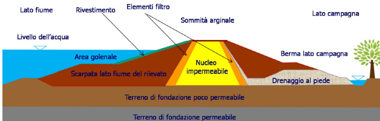
Figura 1: elementi che compongono una generica sezione arginale (CIRIA et al., 2013)
