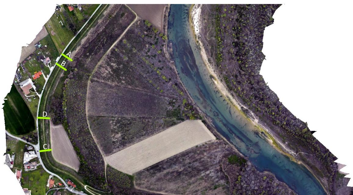
Figura 23: posizionamento dei transetti lungo la struttura arginale
