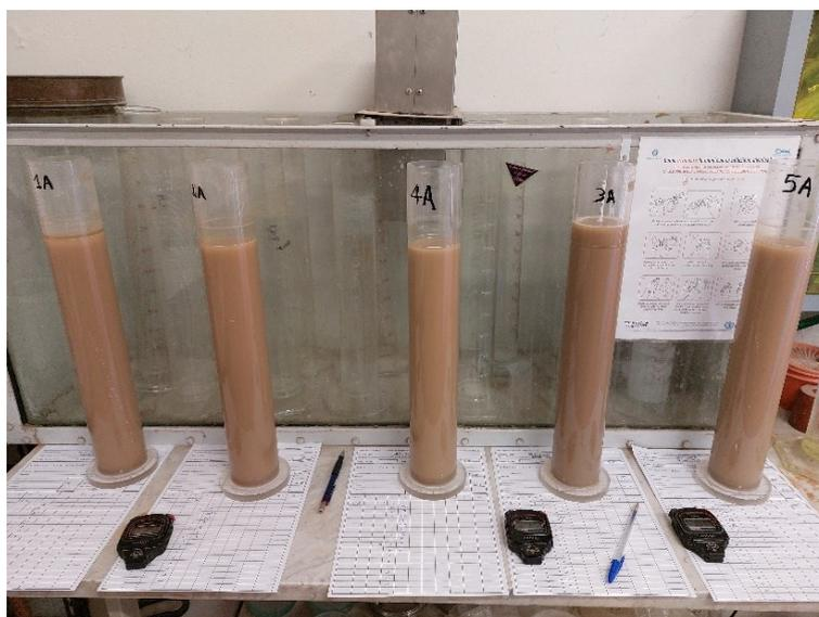
*Figura 27: strumentazione per l'aerometria*
