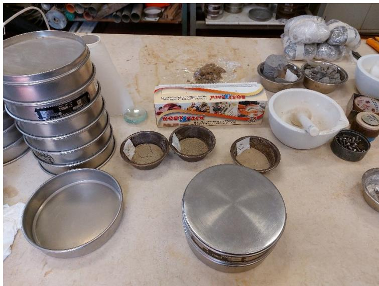
*Figura 26: strumentazione per la vagliatura meccanica a secco*
