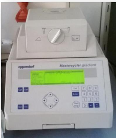
Figura 29 : Termociclatore utilizzato per la RFLP degli amplificati.
