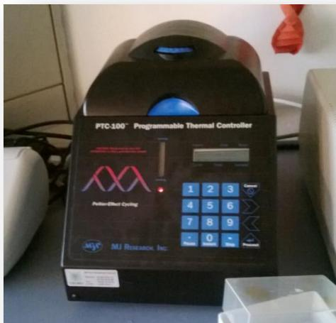
Figura 28 : Termociclatore PTC – 100 utilizzato per l'amplificazione del DNA mitocondriale.
