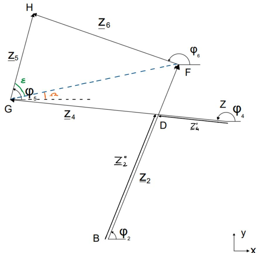
$$(a_4 - a'_4) \begin{Bmatrix} -\sin \varphi_4 \\ \cos \varphi_4 \end{Bmatrix} \dot{\varphi}_4 + a_5 \begin{Bmatrix} -\sin \varphi_5 \\ \cos \varphi_5 \end{Bmatrix} \dot{\varphi}_5 - a_6 \begin{Bmatrix} -\sin \varphi_6 \\ \cos \varphi_6 \end{Bmatrix} \dot{\varphi}_6 - (a_2 - a''_2) \begin{Bmatrix} -\sin \varphi_2 \\ \cos \varphi_2 \end{Bmatrix} \dot{\varphi}_2 = \begin{Bmatrix} 0 \\ 0 \end{Bmatrix}$$
