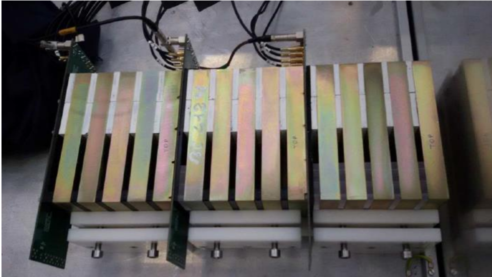
Fig. 6: Una foto del prototipo composto da 12 UCM (tratta da [9]). È visibile anche lo stato di verniciatura a base di \text{TiO}_2 sulle tiles .
