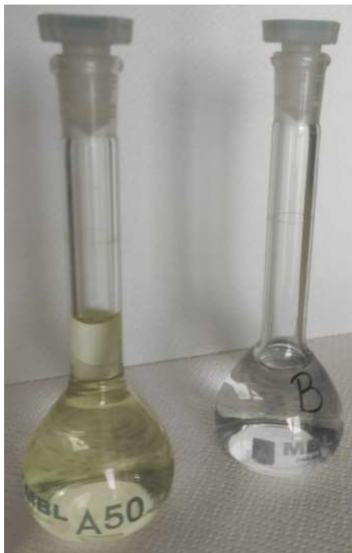
Figura 33. Fotografia dove a sinistra vi è il matraccio contenente l'analita dopo l'aggiunta del reattivo di Nessler mentre a destra vi è il bianco.
