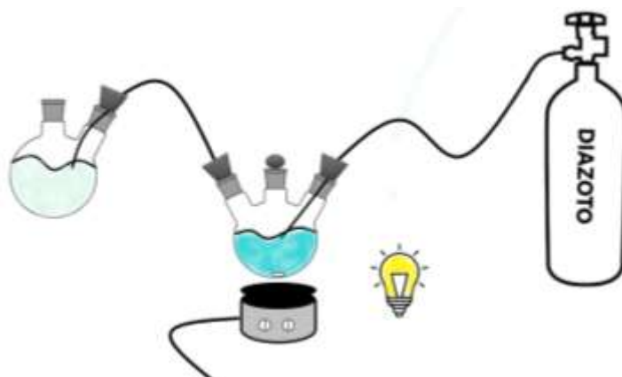
Figura 31. Schema figurativo del sistema per effettuare la prima prova fotocatalitica.
