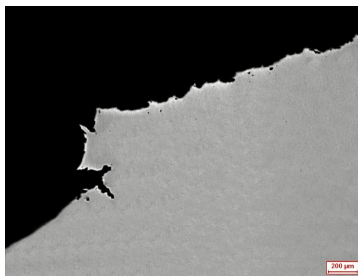
Figura 3.44 - Micrografia della radice dell'intaglio del campione B13 vista al microscopio ottico a 50x.
