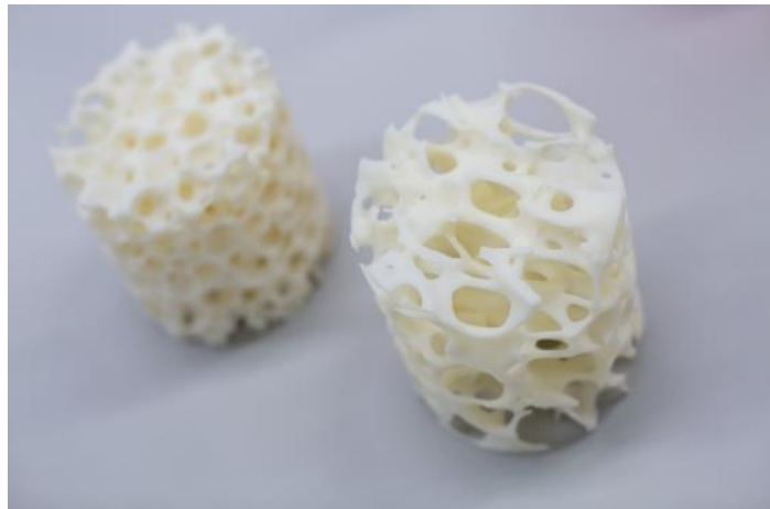
Figura 2: Scaffold di Bioglass poroso 2
