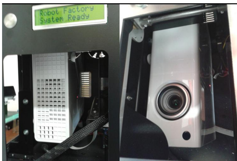
Figura 16: Proiettore Acer interno alla stampante; la foto è stata scattata una volta rimosso il pannello metallico anteriore
