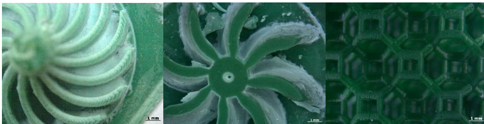
Figura 40: Diverse geometrie create con la stampante Stereolitografica: MiniTurbine e particolare di una struttura a cella di Kelvin
