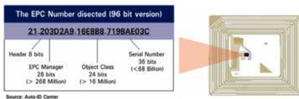
Figura 2.2: Struttura del codice EPC.
