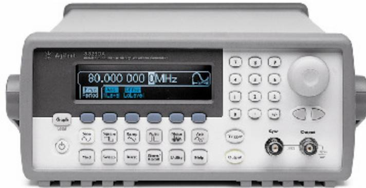
Il generatore di funzioni , è in grado di fornire in uscita al massimo 10mA. E' bene usarlo attorno ai 2mA altrimenti lo strumento reagisce arrotondando i fronti del segnale. Per applicazioni che richiedono più corrente è indispensabile ricorrere ad un buffer. È possibile settare l'impedenza d'uscita, per evitare l'effetto partitore.
