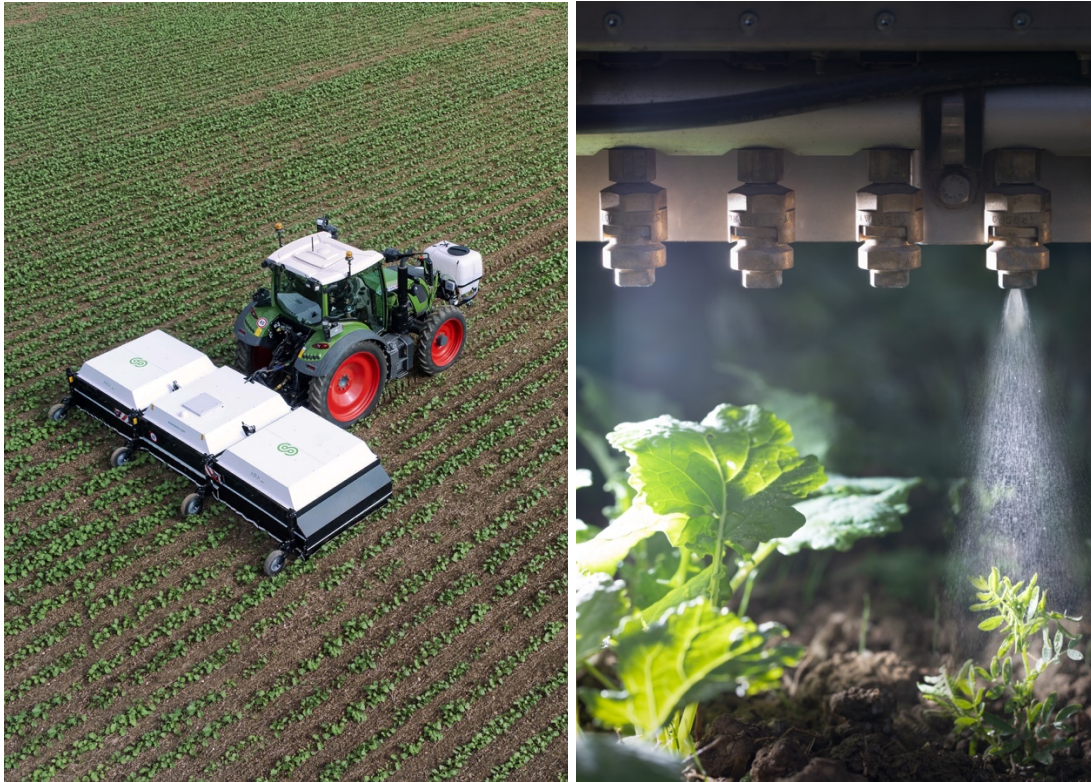
Figura 1: (a sinistra) Nebulizzatore ad alta precisione ARA, Ecorobotix. (a destra) Ugelli selettivi in funzione del dispositivo ARA
