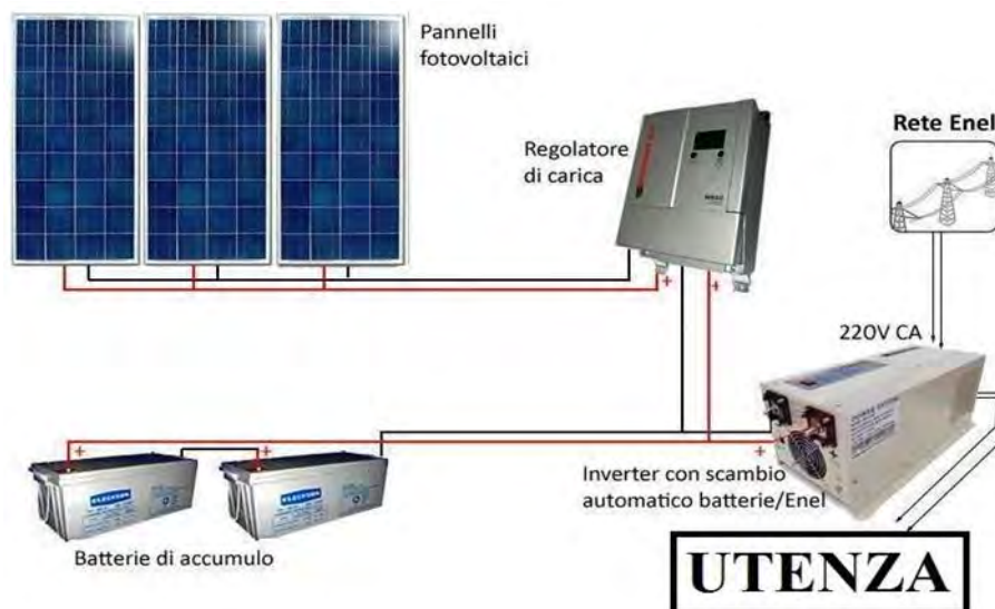
Figura 1.29 Schema di impianto fotovoltaico con batterie connesso alla rete. [18]
