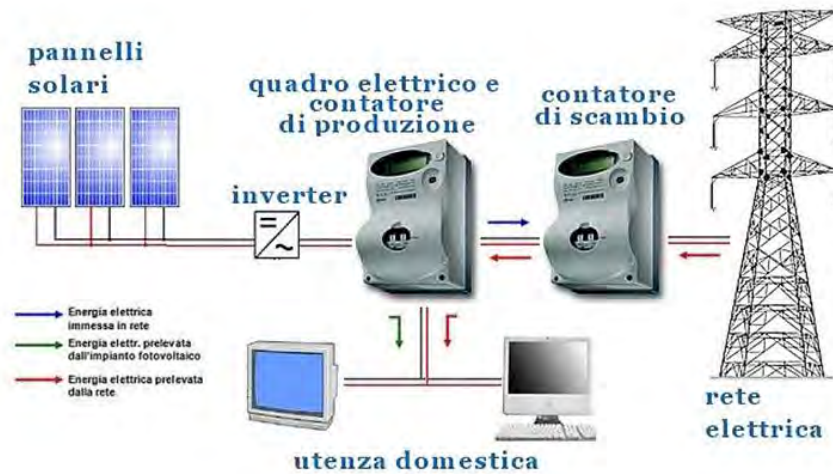
Figura 1.28 Schema di impianto fotovoltaico connesso alla rete. [17]
